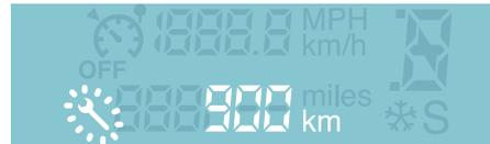
Ein paar Sekunden nach dem Einschalten der Zündung wird der Ölstand angezeigt, anschließend nimmt der Kilometerzähler seine normale Funktion wieder auf, der Schlüssel bleibt jedoch erleuchtet. Er weist darauf hin, dass in Kürze eine Wartung fällig ist.
