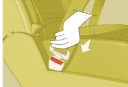
Der Beckengurt muss so tief wie möglich am Becken anliegen. Der Schultergurt muss über die Schulter verlaufen, und zwar so, dass er nicht am Hals anliegt. Vergewissern Sie sich, dass der Gurt richtig eingerastet ist, indem Sie daran ziehen.
