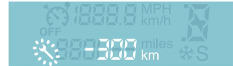
**i** Bei laufendem Motor bleibt der Schlüssel so lange erleuchtet, bis die Wartung durchgeführt wurde.
