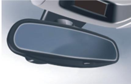
Mit Hilfe eines Sensors, der die Lichtverhältnisse hinter dem Fahrzeug misst, stellt sich der Rückspiegel selbsttätig und stufenlos von Tageslicht auf Dunkelheit um.
