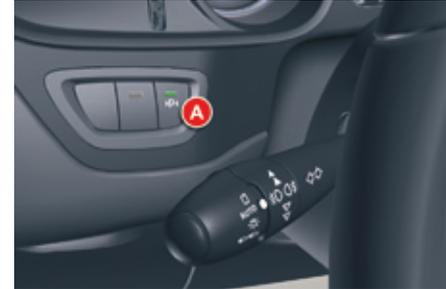
Die Funktion "Parklückendetektor" wird durch Drücken auf die Betätigung **A** aktiviert. Das ständige Einschalten der Kontrollleuchte weist auf die Auswahl der Funktion hin.
