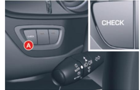
Diese Funktion ermöglicht die Anzeige des Journals der Warnmeldungen.
