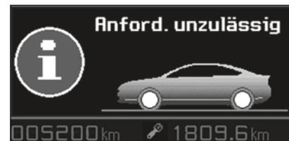
In der Multifunktionsanzeige sieht man vorübergehend eine Meldung, dass die Einstellung nicht möglich ist. Das Fahrzeug bleibt in der zulässigen Position und die Multifunktionsanzeige des Kombiinstrumentes zeigt diese Position an.
