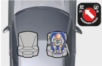
Wenn ein Kindersitz "entgegen der Fahrtrichtung" auf dem **Beifahrersitz vorne** eingebaut wird, muss der Sitz des Fahrzeugs in die mittlere Längsposition, in höchste Position und mit gerader Rückenlehne eingestellt werden.
