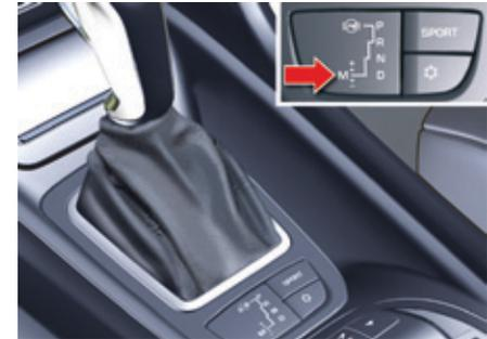
Position des Wählhebels für die manuelle Schaltung der Gänge:
