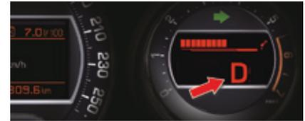
Die vom Fahrer ausgewählte Wählhebelposition und der Fahrmodus werden im rechten Anzeigefeld des Kombiinstrumentes angezeigt.
