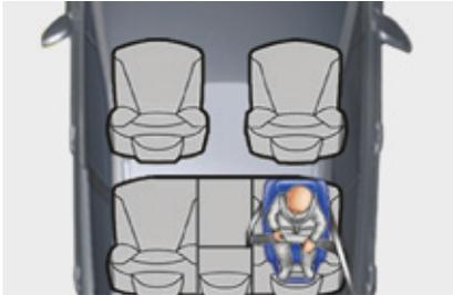
Wenn ein Kindersitz "entgegen der Fahrtrichtung" auf einem **Rücksitz** eingebaut wird, schieben Sie den Vordersitz des Fahrzeugs nach vorne und richten Sie die Rückenlehne auf, sodass der Kindersitz "entgegen der Fahrtrichtung" nicht den Vordersitz des Fahrzeugs berührt.
