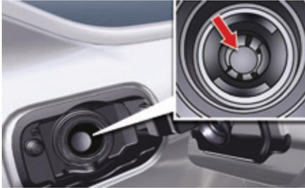
Die Benzin-Zapfpistole stößt beim Einführen in den Tankbehälter Ihres Diesel-Fahrzeugs auf eine Klappe. Das System bleibt gesperrt und verhindert die Befüllung mit Benzin.
