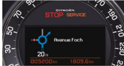
Sie können die Navigations-Informationen durch Drehen des linken Einstellrads am Lenkrad auf dem Bildschirm des Kombiinstrumentes aufrufen.
