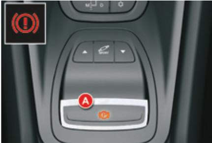
Bei einer Störung des Hauptbremssystems oder in außergewöhnlichen Situationen (Beispiel: Unwohlsein des Fahrers, begleitetes Fahren, ...) können Sie durch Anziehen und Halten der Betätigung **A** das Fahrzeug anhalten.
