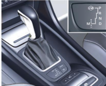
Automatikgetriebe, das frei nach Wahl den Komfort einer Vollautomatik mit einem Sport- und einem Schnee-Programm oder das manuelle Schalten der Gänge bietet.
