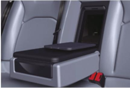
In der Rückenlehne hinter der Armlehne ist eine Klappe angebracht, die den Transport langer Gegenstände ermöglicht.
