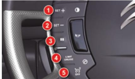
Die Bedientasten für die Geschwindigkeitsregelung befinden sich auf der linken Seite des Lenkrads.
