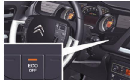
Bei einer Funktionsstörung blinkt die Taste "**ECO OFF**" und leuchtet anschließend ununterbrochen auf. Lassen Sie das System von einem CITROËN-Vertragspartner oder einer qualifizierten Fachwerkstatt überprüfen.
