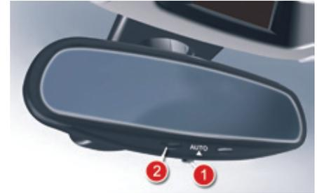
Bei Fahrzeugen mit elektrisch abblendbaren Außenspiegeln verfügt die Tag-/Nachtautomatik über einen EIN/AUS Schalter und eine dazugehörige Kontrollleuchte.
