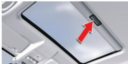
Das Schiebedach Ihres Fahrzeugs verfügt über eine manuell betätigte Verdunklungsjalousie.
