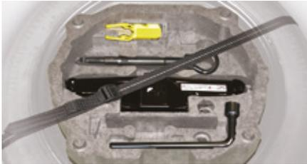
Bei Fahrzeugen, die ein **vollwertiges Ersatzrad** haben, befinden sich die Werkzeuge in einem Werkzeugbehälter im Reserverad.
