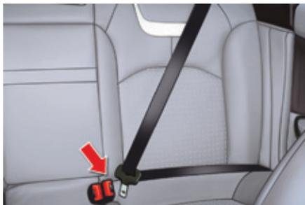
Die Rücksitze sind mit drei Gurten ausgerüstet, von denen jeder über eine Dreipunktverankerung und eine Aufrollvorrichtung mit Gurtkraftbegrenzer verfügt.
