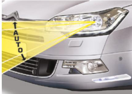
Um andere Verkehrsteilnehmer nicht zu behindern, korrigiert dieses System im Stand automatisch die Höhe des Xenon-Scheinwerferkegels entsprechend der Fahrzeugbeladung.
