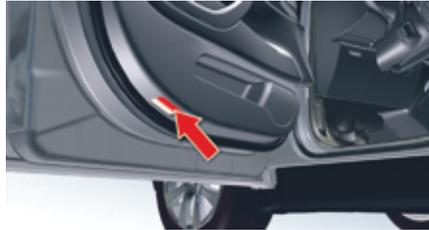
Ermöglicht bei offener Tür die Beleuchtung des Bodens vor dem Fahrzeug.
