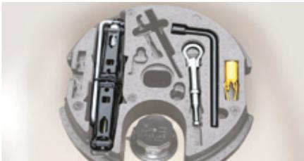
Bei Fahrzeugen, die mit einem **"Notrad"** ausgestattet sind, sind die Werkzeuge in einem Staukasten im Reserverad untergebracht.
