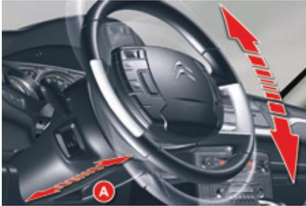
! Aus Sicherheitsgründen darf das Lenkrad nur bei stehendem Fahrzeug verstellt werden.
