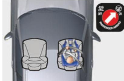
Wenn ein Kindersitz "in Fahrtrichtung" auf dem **Beifahrersitz vorne** installiert wird, schieben Sie den Fahrzeugsitz in höchste Position in die mittlere Längsposition, stellen Sie die Lehne senkrecht und lassen Sie den Beifahrer-Front-Airbag aktiviert.
