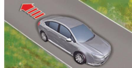
**Im Gefälle wird das stehende Fahrzeug bei eingelegtem Rückwärtsgang kurzzeitig angehalten, wenn das Bremspedal gelöst wird.**
