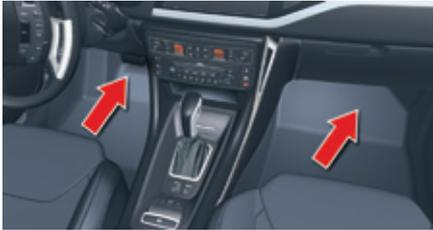
Diese ermöglicht bei Öffnen einer Tür die Beleuchtung des Fahrzeuginnenraums vorne.
