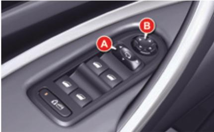
Spiegel für die seitliche Sicht nach hinten, die wichtig zum Überholen oder Einparken ist. Sie können auch eingeklappt werden.
