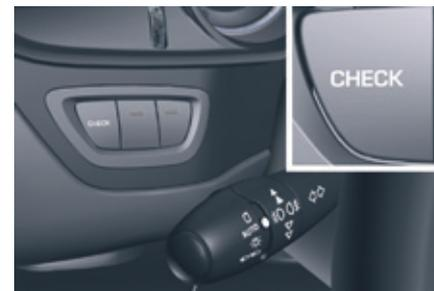
Das Drücken dieser Taste ermöglicht die kurze Anzeige der Fahrreichweite. Ab 5 000 km wird der Wert nicht präzisiert.
