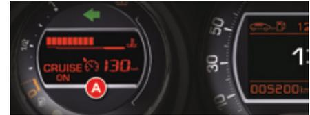
Die mit dem Geschwindigkeitsregler zusammenhängenden Informationen werden im Bereich **A** des Kombiinstrumentes angezeigt.
