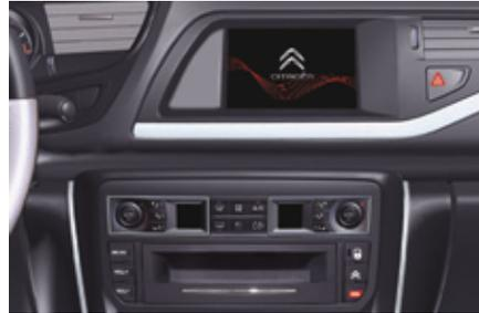
**i** Bei sehr starker Hitze, kann das System sich für eine Mindstdauer von 5 Minuten deaktivieren (Bildschirm und Ton erlischt komplett).
