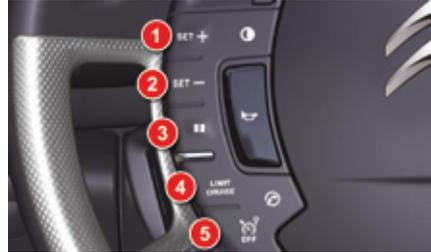
Die Betätigungen für die Geschwindigkeitsbegrenzung befinden sich auf der linken Seite des Lenkrads.
