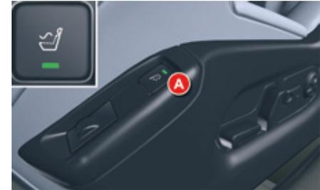
Diese Funktion bietet eine Rückenmassage und kann nur bei laufendem Motor aktiviert werden.
