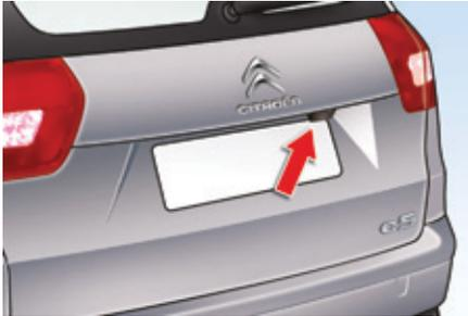
Bei Einlegen des Rückwärtsgangs wird eine Rückfahrkamera automatisch aktiviert. Das Bild erscheint auf dem Navigationsbildschirm.
