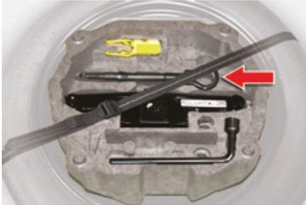
Die Abschleppöse befindet sich im Schutzbehälter des Wagenhebers im Reserverad.
