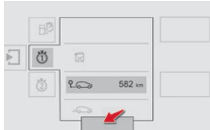
System, welches eine Strecke misst (z.B. täglich), die seit der Rückstellung der Anzeige auf null durch den Fahrer zurückgelegt wurde.
