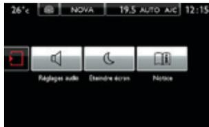
Einstellung des Klangs (Balance, Klangbild, ...), der Helligkeit der Bedienungseinheit, der Anzeige (Sprache, Einheiten, Datum, Uhrzeit, ...) und Zugriff auf die interaktive Hilfe zu den wesentlichen Ausstattungen und Kontrollleuchten des Fahrzeugs.
