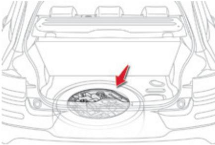
Das Werkzeug befindet sich im Kofferraum unter dem Boden oder kann sich, je nach Version, unter dem Beifahrersitz vorne befinden.
