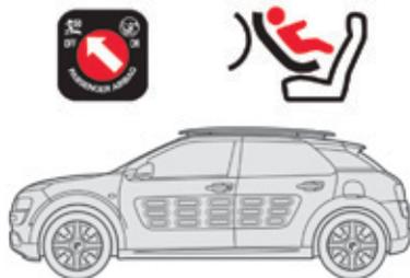
Wenn ein Kindersitz "entgegen der Fahrtrichtung" auf dem **Beifahrersitz vorne** eingebaut wird, muss der Sitz des Fahrzeugs in die mittlere Längsposition und mit gerader Rückenlehne eingestellt werden.
