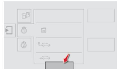
☞ Drücken Sie, wenn die gewünschte Strecke angezeigt wird, auf die Taste "Reset" für die Rückstellung auf null oder auf das Ende des Scheibenwischersalters bis zum Erscheinen der Nullen.
