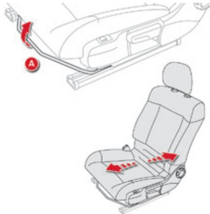
☞ Heben Sie den Bügel **A** an und schieben Sie den Sitz nach vorne oder hinten.
