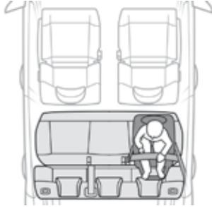
Wenn ein Kindersitz "entgegen der Fahrtrichtung" auf einem **Rücksitz** eingebaut wird, schieben Sie den Vordersitz des Fahrzeugs nach vorne und richten Sie die Rückenlehne auf, sodass der Kindersitz "entgegen der Fahrtrichtung" nicht den Vordersitz des Fahrzeugs berührt.
