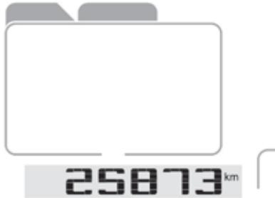
System, welches die vom Fahrzeug während seiner Lebensdauer insgesamt zurückgelegte Kilometerzahl misst.
