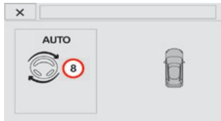
Das von dem Parkassistenten unterstützte Einparkmanöver läuft. Fahren Sie mit den Manövern fort, ohne eine Geschwindigkeit von 7 km/h zu überschreiten und folgen Sie dabei den von der "Einparkhilfe" angegebenen Informationen, bis die Meldung über das Ende des Manövers erscheint. Die Kontrollleuchte der Betätigung erlischt in Verbindung mit einem akustischen Signal.
