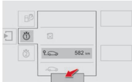
System, welches eine Strecke misst (z.B. täglich), die seit der Rückstellung der Anzeige auf null durch den Fahrer zurückgelegt wurde.
