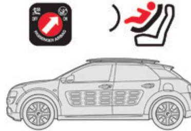
Wenn ein Kindersitz "in Fahrtrichtung" auf dem **Beifahrersitz vorne** installiert wird, schieben Sie den Fahrzeugsitz in die mittlere Längsposition, stellen Sie die Lehne senkrecht und lassen Sie den Beifahrer-Front-Airbag aktiviert.
