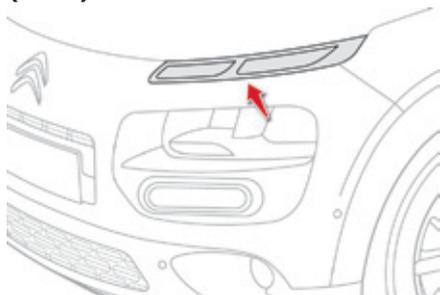
Die Leuchtdioden (LED) schalten sich automatisch nach dem Starten des Motors ein.
