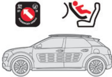
Wenn ein Kindersitz "entgegen der Fahrtrichtung" auf dem **Beifahrersitz vorne** eingebaut wird, muss der Sitz des Fahrzeugs in die mittlere Längsposition und mit gerader Rückenlehne eingestellt werden. Der Beifahrer-Front-Airbag muss unbedingt deaktiviert werden. Andernfalls **könnte das Kind beim Entfalten des Airbags schwere oder sogar tödliche Verletzungen erleiden.**
