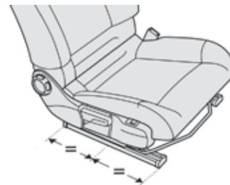
Beifahrersitz in mittlerer Längseinstellung.
