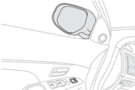
Spiegel für die seitliche Sicht nach hinten, die wichtig zum Überholen oder Einparken sind. Zum Parken an einem Engpass können sie auch eingeklapppt werden.
