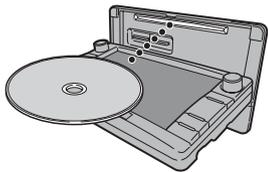
**OPEN:** hiermit wird das Display geöffnet oder geschlossen, um eine CD oder die SD-Karten einzulegen oder zu entfernen.
