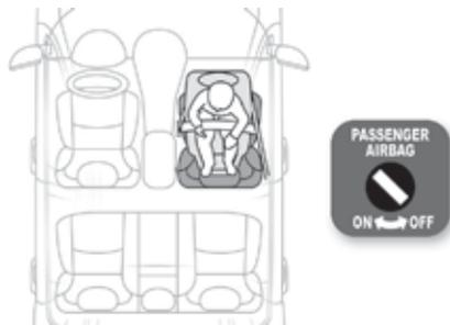
Wenn ein Kindersitz "entgegen der Fahrtrichtung" auf dem **Beifahrersitz vorne** eingebaut wird, muss der Sitz des Fahrzeugs in die mittlere Längsposition, in hoher Position und mit gerader Rückenlehne eingestellt werden.
