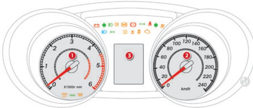
Einheit mit Messinstrumenten und Kontrollleuchten. Diese informieren den Fahrer über den Betriebszustand eines Systems (ein oder aus) oder eine aufgetretene Anomalie (Warnleuchten).
