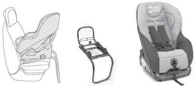
Wird entgegen der Fahrtrichtung mit Hilfe einer ISOFIX-Basis eingebaut, die an den Ösen A befestigt wird. Die Basis verfügt über eine Stützvorrichtung. 6 Neigungspositionen der Schale. Diese Konfiguration ist Kindern vorbehalten, die weniger als 13 kg wiegen.
