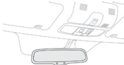
Mit Hilfe eines Sensors, der die Lichtverhältnisse hinter dem Fahrzeug misst, stellt sich der Rückspiegel selbsttätig und stufenlos von Tageslicht auf Dunkelheit um.
