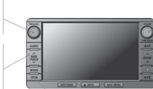
**FOLDER:** ermöglicht die Auswahl eines Ordners oder die manuelle Suche eines Radiosenders.
