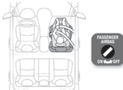
Wenn ein Kindersitz "in Fahrtrichtung" auf dem **Beifahrersitz vorne** installiert wird, schieben Sie den Fahrzeugsitz in hoher Position in die mittlere Längsposition, stellen Sie die Lehne senkrecht und lassen Sie den Beifahrer-Airbag aktiviert.
