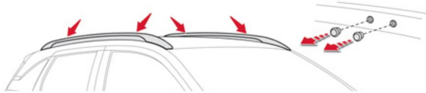
Die Querträger werden mit Hilfe von 8 unter Abdeckungen versteckten Verankerungspunkten auf den Längsträgern befestigt.
