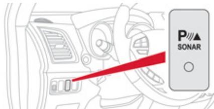
Die Einparkhilfe hinten wird beim Einlegen des Rückwärtsgangs aktiviert. Dies wird durch ein akustisches Signal angezeigt.
