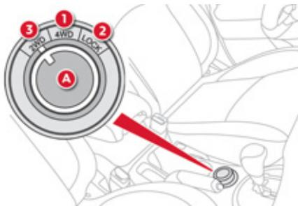
Sie können den Antriebsmodus im Stand oder während der Fahrt wechseln. Der Antriebsmodus kann durch Drehen des Reglers **A** ausgewählt werden.
