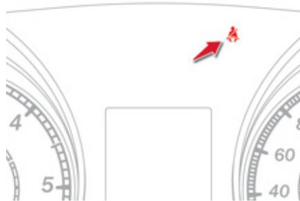
Wenn der Fahrer seinen Gurt innerhalb einer Minute nach Einschalten der Zündung nicht anlegt, blinkt die Warnleuchte in Verbindung mit einem unterbrochenen akustischen Signal und einer Meldung auf dem Bildschirm des Kombiinstrumentes.
