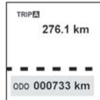
Die Gesamtkilometerleistung wird im unteren Teil des Bildschirms angezeigt.
