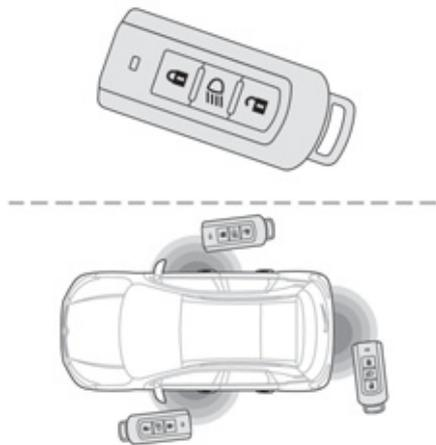
System, mit dem sich das Fahrzeug entriegeln, verriegeln und starten lässt, indem man den elektronischen Schlüssel bei sich trägt. Er kann außerdem als Fernbedienung genutzt werden, siehe Abschnitt "Fernbedienung".
