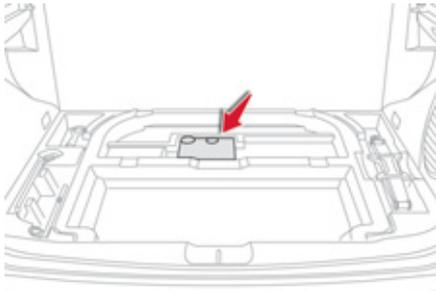
Das Reifenpannsenset befindet sich im Kofferraum unter dem Boden.
