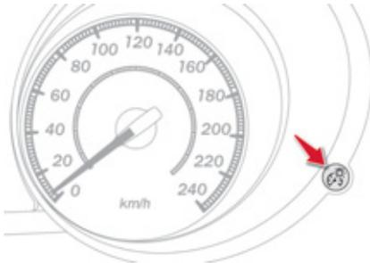
Drücken Sie bei ein- oder ausgeschalteten Scheinwerfern auf den Knopf, um die Beleuchtungsintensität des Bedienfelds bei Tages- bzw. Nachtbedingungen zu ändern.
