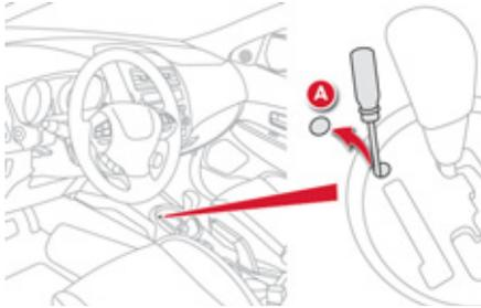
Wenn die Batterie entladen ist oder wenn der Blockiermechanismus des Gangwählhebels beschädigt ist, kann es sein, dass der Hebel in der Position **P** blockiert ist, auch wenn Sie fest auf das Bremspedal treten.
