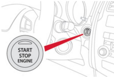
Mit dem elektronischen Schlüssel im Inneren des Fahrzeugs; mit jedem Drücken auf die Taste " **START/STOP** ", **ohne Betätigung der Pedale** können Sie die Modi des Fahrzeugs ändern:
