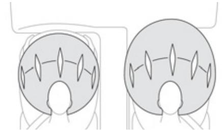
System, das bei einem starken Frontalaufprall Fahrer und Beifahrer schützt und die Verletzungsgefahr an Kopf und Oberkörper vermindert.
