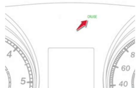
Wenn Sie die Taste 1 drücken, leuchtet die Kontrollleuchte **"CRUISE"** im Kombiinstrument auf.
