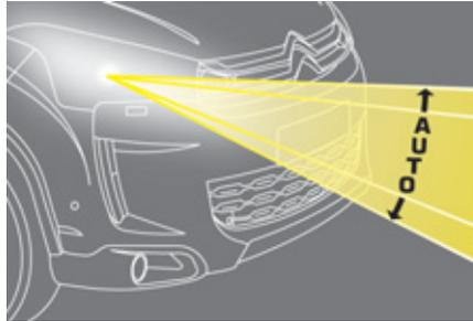
Bei Fahrzeugen mit Xenon-Lampen: **im Stillstand** wird die Scheinwerferhöhe automatisch entsprechend der Fahrzeugbeladung verstellt. So kann der Fahrer sicher sein, dass die Beleuchtung optimal ist und andere Verkehrsteilnehmer nicht geblendet werden.
