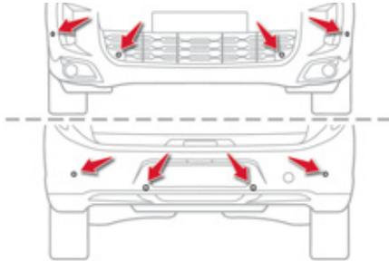
Mit Hilfe von Sensoren im Stoßfänger zeigt Ihnen diese Funktion den Abstand zu einem Hindernis (Person, Fahrzeug, Baum, Schranke...) an, das sich im Erfassungsbereich befindet.
