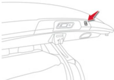
In Verbindung mit dem optionalen Navigationssystem wird beim Einlegen des Rückwärtsgangs automatisch eine Rückfahrkamera aktiviert, welche die Funktion der Einparkhilfe ergänzt.
