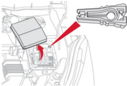
Die Zange zum Abziehen und die Ersatzsicherungen befinden sich im Sicherungskasten im Motorraum.
