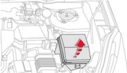
Der Sicherungskasten befindet sich im Motorraum (linke Seite).
