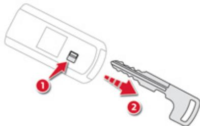
Der integrierte Schlüssel dient zum Ver- bzw. Entriegeln des Fahrzeugs, wenn der elektronische Schlüssel unter folgenden Bedingungen nicht funktioniert:
