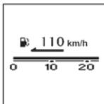
Gibt **bei laufendem Motor** die Kilometerzahl an, für die der im Tank verbleibende Kraftstoff, je nach durchschnittlichem Verbrauch der letzten gefahrenen Kilometer, ausreicht.
