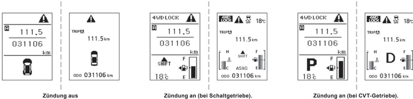
Bei jedem Anlassen des Motors leuchten im Rahmen einer Selbstdiagnose Kontrollleuchten und/oder Meldungen auf. Sie erlöschen sofort wieder.
