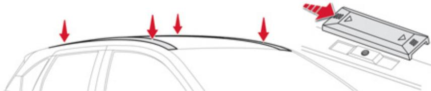
Die Querträger werden mit Hilfe von 4 unter Abdeckungen versteckten Verankerungspunkten direkt auf dem Dach befestigt.
