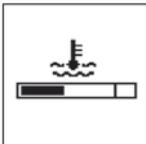
Bei laufendem Motor gibt sie die Kühflüssigkeitstemperatur an.
