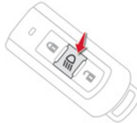
Dieser Schalter funktioniert nur, wenn die **Zündung ausgeschaltet** ist und der Beleuchtungsschalter in der Position **"OFF"** oder **"AUTO"** steht.
