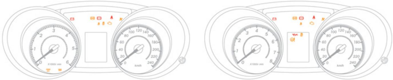
Anzeigen, die den Fahrer über das Auftreten einer Funktionsstörung (Warnleuchten) oder die Aktivierung eines Systems (Kontrollleuchten für Betrieb oder Deaktivierung) informieren.
