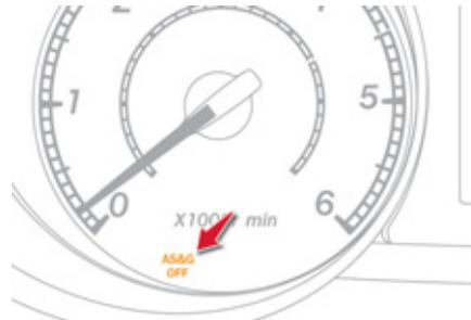
Bei einer Funktionsstörung blinkt die Kontrollleuchte **"AS&G OFF"** im Kombiinstrument oder in der Anzeige des Kombiinstrumentes und das System funktioniert nicht mehr. Lassen Sie das System von einem CITROËN-Vertragspartner oder einer qualifizierten Fachwerkstatt überprüfen.
