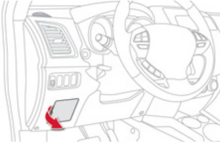
Der Sicherungskasten befindet sich im unteren Teil des Armaturenbretts (linke Seite).
