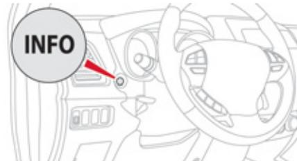
Wenn der gewünschte Wert angezeigt wird, drücken Sie die Taste **INFO** länger als zwei Sekunden, um alle Daten wieder auf null zu stellen. Beim Einschalten der Zündung schaltet die Nullrückstellung automatisch vom manuellen in den automatischen Modus.
