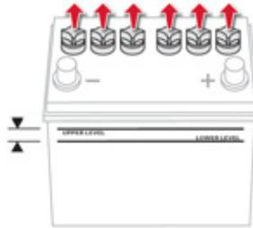
Wenn nötig, füllen Sie destilliertes Wasser nach; dazu entfernen Sie die Deckel der verschiedenen Batteriezellen.
