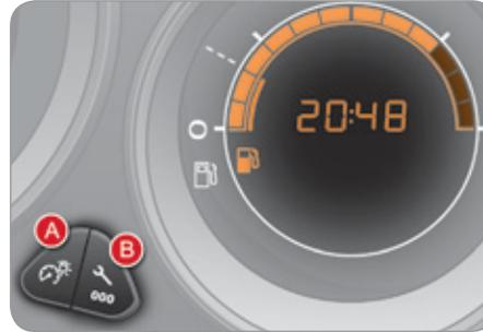
Zum Einstellen der Uhrzeit, verwenden Sie die Schalter **A** und **B** des zweifarbigen Kombiinstrumentes ohne Autoradio. Führen Sie anschließend die Schritte in der folgenden Reihenfolge durch:
