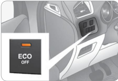
Bei einer Funktionsstörung blinkt die Taste "ECO OFF" und leuchtet anschließend ununterbrochen auf. Lassen Sie das System von einem CITROËN-Vertragspartner oder einer qualifizierten Fachwerkstatt überprüfen.
