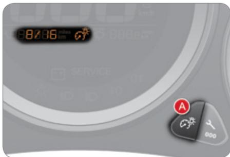
Hiermit lässt sich die Helligkeit der Bedienungseinheit je nach Lichteinfall von außen manuell einstellen. Funktioniert nur bei eingeschaltetem Licht im Modus Nacht.
