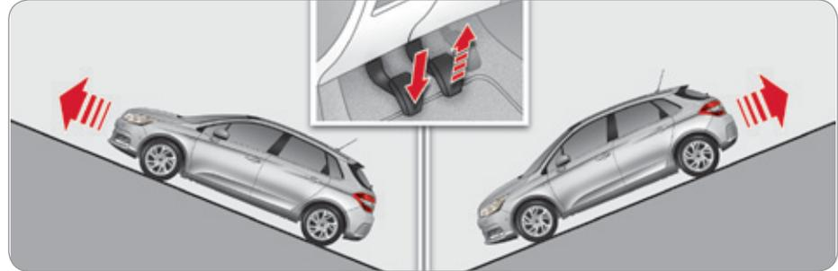
**An Steigungen wird das stehende Fahrzeug beim Lösen des Bremspedals kurzzeitig angehalten:**
