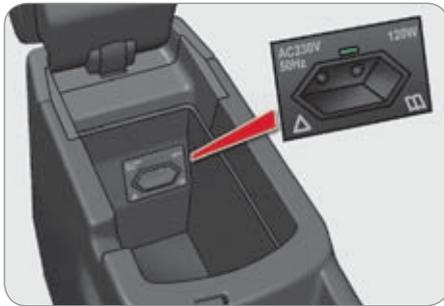
Ein 230V- / 50 Hz-Anschluss (Höchstleistung: 120 W) ist in der Mittelkonsole eingebaut.
