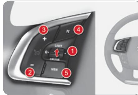
Die Bedienung des Geschwindigkeitsbegrenzers erfolgt über den Hebel am Lenkrad.
