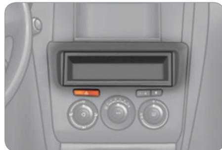
☞ Haken Sie die Ablage mithilfe eines Schraubenziehers an jeder Seite aus und ziehen Sie sie anschließend heraus.
