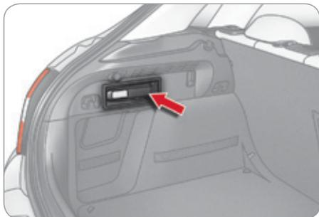
Herausnehmbare Leuchte in der Wand des Kofferraums, die gleichzeitig als Kofferraumleuchte und als Taschenlampe dient.
