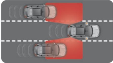
Dieses Fahrassistenzsystem informiert den Fahrer, wenn sich ein herannahendes Fahrzeug im toten Winkel (Bereich außerhalb des Sichtfelds des Fahrers) seines Fahrzeugs befindet, sobald dies eine mögliche Gefahr darstellt.
