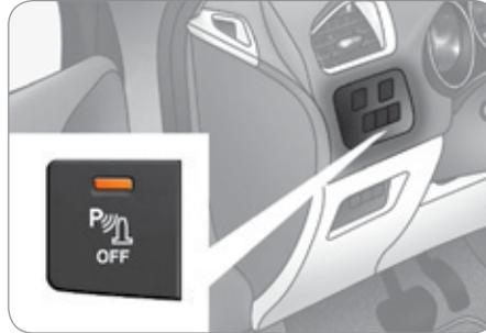
Die Einparkhilfe wird durch Betätigung dieses Schalters deaktiviert. Die Kontrollleuchte des Schalters leuchtet auf.
