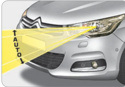
Um andere Verkehrsteilnehmer nicht zu behindern, korrigiert dieses System im Stand automatisch die Höhe des Xenon-Scheinwerferkegels entsprechend der Fahrzeugbelastung.
