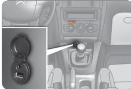
Die Anschlusseinheit "AUX" an der Mittelkonsole besteht aus einem JACK-Anschluss und/oder einem USB-Ausgang.
