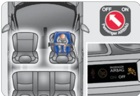
Wenn ein Kindersitz "entgegen der Fahrtrichtung" auf dem **Beifahrersitz vorne** eingebaut wird, muss der Sitz des Fahrzeugs in die mittlere Längsposition, in höchste Position und mit gerader Rückenlehne eingestellt werden.
