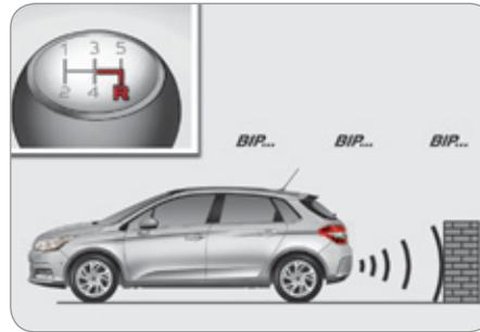
Die Einparkhilfe hinten wird beim Einlegen des Rückwärtsgangs aktiviert. Dies wird durch ein akustisches Signal angezeigt.
