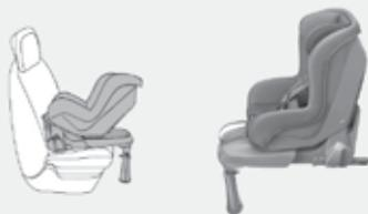
Einbau "entgegen der Fahrtrichtung" mit Hilfe einer ISOFIX-Basis, die an den Ösen **A** zu befestigen ist.
