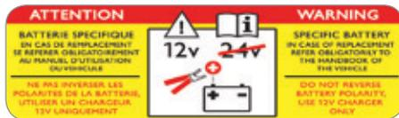
Das Vorhandensein dieses Aufklebers, insbesondere beim STOP & START-System, weist auf die Verwendung einer bleihaltigen 12V-Batterie mit spezieller Technologie und Eigenschaften hin. Der Austausch oder das Abklemmen dieser Batterie ist in jedem Fall durch einen CITROËN-Vertragspartner oder eine qualifizierte Fachwerkstatt vorzunehmen.
