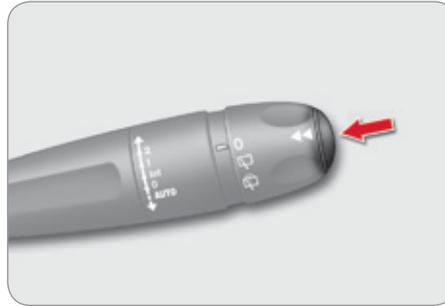
☞ Drücken Sie auf die Taste am Ende des **Scheibenwischerschalters**, um hintereinander die verschiedenen Felder des Bordcomputers abruufen zu lassen.
