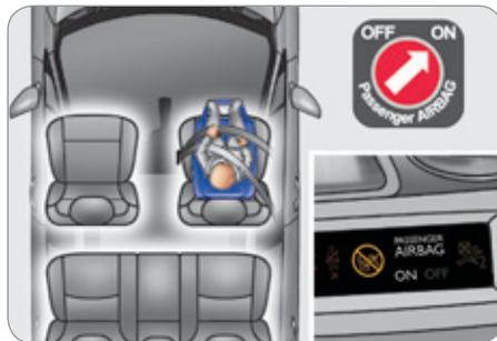
Wenn ein Kindersitz "in Fahrtrichtung" auf dem **Beifahrersitz vorne** installiert wird, schieben Sie den Fahrzeugsitz in höchste Position in die mittlere Längsposition, stellen Sie die Lehne senkrecht und lassen Sie den Beifahrer-Front-Airbag aktiviert.
