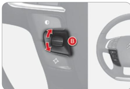
Die Beleuchtungsintensität können Sie ebenfalls durch Drehen des Einstellrads **B**, das sich links vom Lenkrad befindet, ändern:
