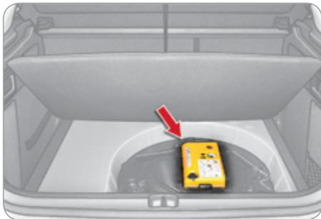
Das Reifenpannenset ist im Staukasten unter dem Kofferraumboden untergebracht.
