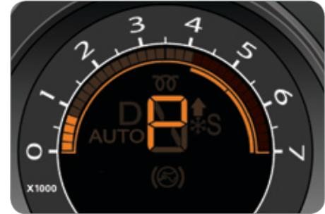
Wenn Sie den Gangwählhebel verstellen, um eine Schaltposition zu wählen, leuchtet die entsprechende Kontrollleuchte im Kombiinstrument auf.
