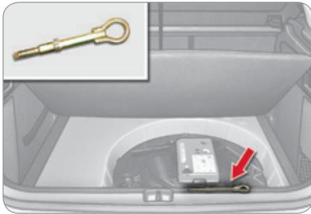
Die Abschleppöse befindet sich unter dem Bodenbelag im Kofferraum.
