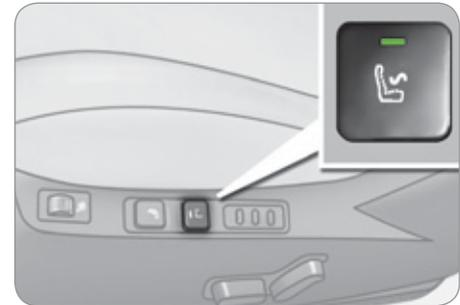
Diese Funktion bietet eine Rückenmassage, die nur bei laufendem Motor aktiviert werden kann.
