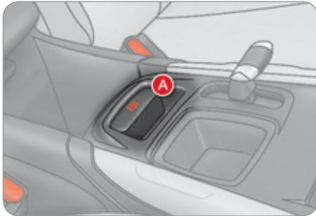
Bei einer Störung der Fußbremsanlage oder in außergewöhnlichen Situationen (Beispiel: Unwohlsein des Fahrers, Fahranfänger in Begleitung etc.) ermöglicht das Anziehen der Betätigung **A** das Anhalten des Fahrzeugs.
