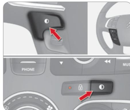
System, das die Deaktivierung bestimmter Anzeigen für die Nachtfahrt ermöglicht.
