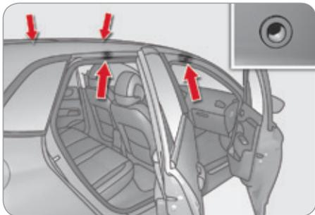
Bei der Montage der Dachträger dürfen diese nur an den vier Verankerungspunkten am Dachrahmen befestigt werden. Diese werden von den Türen, wenn sie geschlossen sind, verdeckt.
