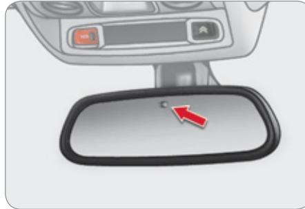
Mit Hilfe eines Sensors, der die Lichtverhältnisse hinter dem Fahrzeug misst, stellt sich der Rückspiegel selbstständig und stufenlos von Tageslicht auf Dunkelheit um.
