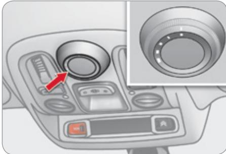
Diese Dachjalousie wird elektrisch über einen Drehschalter bedient.
