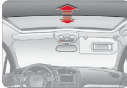
Wenn die Position der Dachjalousie nicht der auf dem Drehschalter angezeigten Position entspricht, drücken Sie den Schalter um die Dachjalousie bis zu dieser Position zu öffnen.
