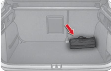
Wenn Ihr Fahrzeug über eine elektrische Feststellbremse verfügt, befindet sich der Wagenheber in einer im Kofferraumboden platzierten Tasche.
