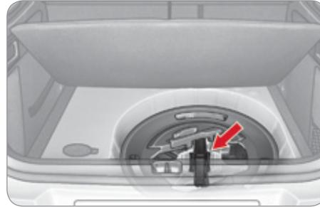
Wenn Ihr Fahrzeug über eine manuelle Feststellbremse verfügt, befindet sich der Wagenheber unter dem Ersatzrad und unter dem Staukasten:
