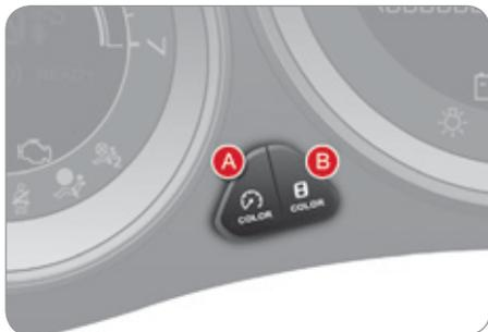
Im Kombiinstrument können Sie die Farbe der Instrumente (Taste **A**) unabhängig von der Farbe der Anzeigen (Taste **B**) ändern.
