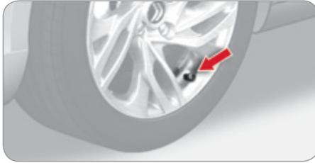
System zur automatischen Kontrolle des Reifendrucks während der Fahrt.
