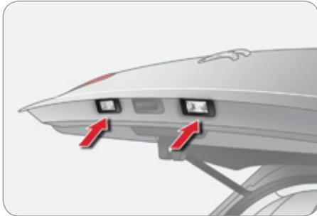
Um Ihnen den Ausbau zu erleichtern, führen Sie diesen Vorgang bei halbgeöffneter Heckklappe durch.
