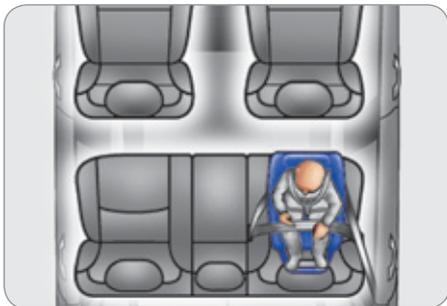
Wenn ein Kindersitz "entgegen der Fahrtrichtung" auf einem **Rücksitz** eingebaut wird, schieben Sie den Vordersitz des Fahrzeugs nach vorne und richten Sie die Rückenlehne auf, sodass der Kindersitz "entgegen der Fahrtrichtung" nicht den Vordersitz des Fahrzeugs berührt.
