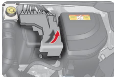
Die Batterie befindet sich im Motorraum.
