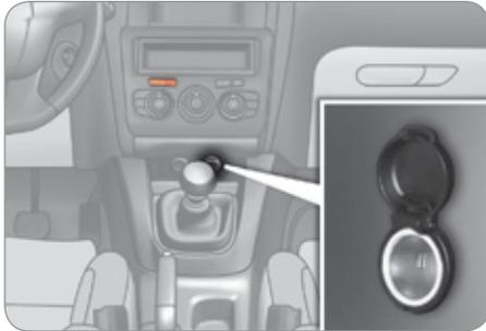
☞ Um ein Zubehörteil mit 12V-Betriebsspannung (maximale Leistung: 120 W) anzuschließen, entfernen Sie die Verschlusskappe und verwenden Sie einen geeigneten Adapter.
