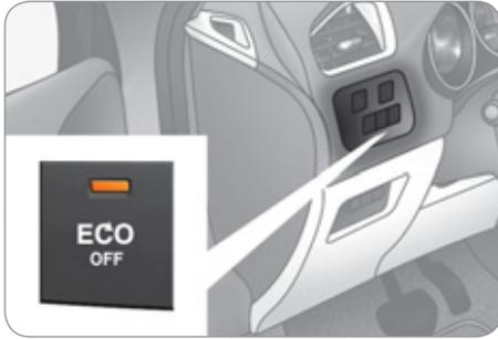
Bei einer Funktionsstörung blinkt die Taste "ECO OFF" und leuchtet anschließend ununterbrochen auf.
