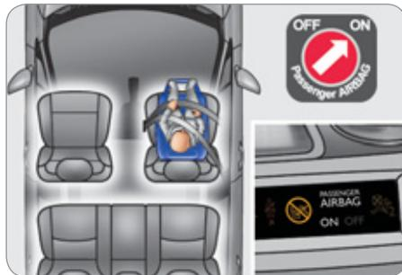
Wenn ein Kindersitz in Fahrtrichtung auf dem **Beifahrersitz vorne** installiert wird, schieben Sie den Fahrzeugsitz in hoher Position in die mittlere Längsposition, stellen Sie die Lehne senkrecht und lassen Sie den Beifahrer-Airbag aktiviert.
