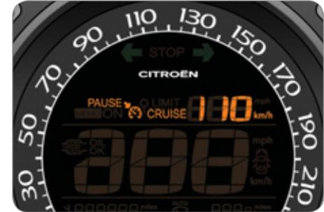
Der Regler- oder Begrenzermodus wird im Kombiinstrument angezeigt, wenn er ausgewählt worden ist.
