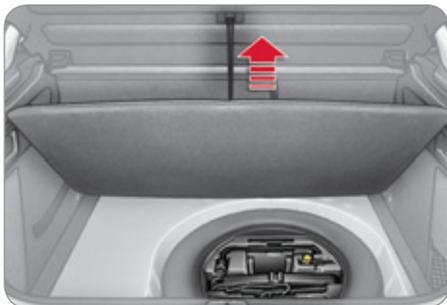
Das Werkzeug befindet sich im Kofferraum unter dem Boden.
