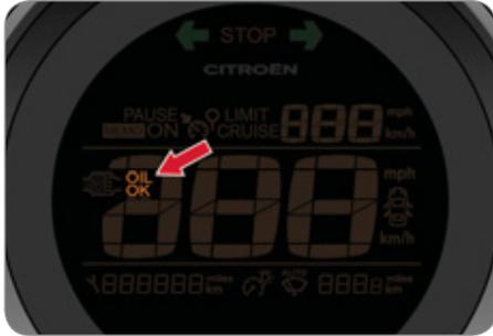
Bei den mit einem elektrischen Ölmesstab ausgestatteten Versionen, wird beim Einschalten der Zündung gleichzeitig mit der Wartungsinformation für die Dauer einiger Sekunden die Konformität des Motorölstands im Kombiinstrument angezeigt.
