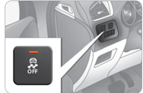
Drücken Sie auf die Taste "ESP OFF", die sich nahe am Lenkrad befindet.
