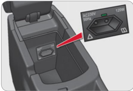
Ein 230V- / 50 Hz-Anschluss (Höchstleistung: 120 W) ist in der Mittelkonsole eingebaut.
