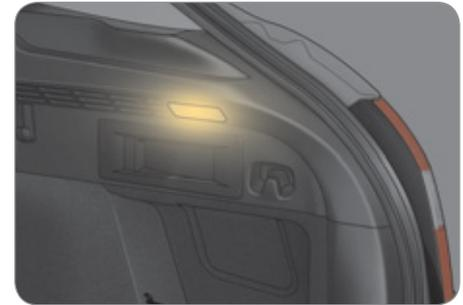
Sie schaltet sich automatisch beim Öffnen des Kofferraums ein und erlischt, wenn er wieder geschlossen wird.
