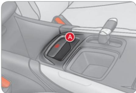
Bei einer Störung der Fußbremsanlage oder in außergewöhnlichen Situationen (Beispiel: Unwohlsein des Fahrers, Fähranfänger in Begleitung etc.) ermöglicht das Anziehen der Betätigung **A** das Anhalten des Fahrzeugs.
