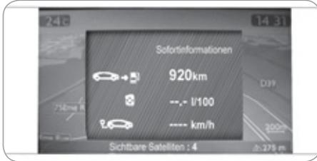
☞ Drücken Sie auf die Taste am Ende des **Scheibenwischerschalters**, um die Daten des Bordcomputers temporär in einem spezifischen Fenster anzuzeigen.
