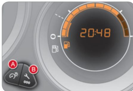
Zum Einstellen der Uhrzeit, verwenden Sie die Schalter **A** und **B** des zweifarbigen Kombiinstrumentes ohne Autoradio. Führen Sie anschließend die Schritte in der folgenden Reihenfolge durch:
