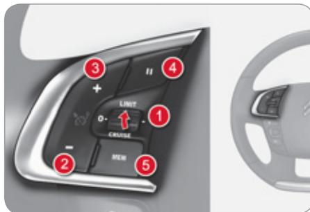
Die Bedienung des Geschwindigkeitsbegrenzers erfolgt über den Hebel am Lenkrad.
