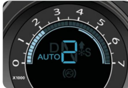
Der eingelegte Gang bzw. der gewählte Fahrmodus erscheinen in der Anzeige im Kombiinstrument.
