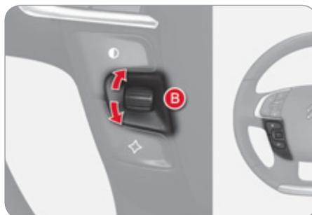
Die Beleuchtungsintensität können Sie ebenfalls durch Drehen des Einstellrads **B**, das sich links vom Lenkrad befindet, ändern:
