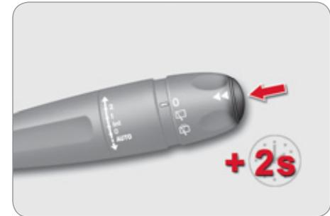
☞ Drücken Sie, wenn die gewünschte Strecke angezeigt wird, länger als zwei Sekunden auf die Taste am Ende der Scheibenwischerbetätigung.
