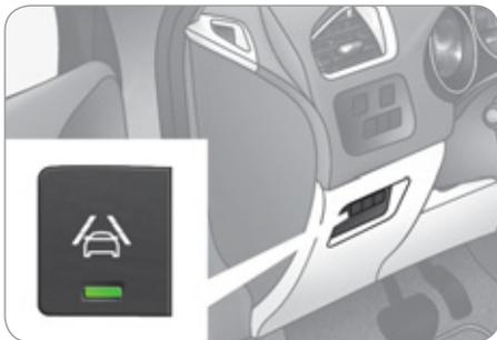
System, das das unbeabsichtigte Überfahren einer Längsmarkierung auf der Fahrbahn erkennt (durchgezogene oder unterbrochene Linie).
