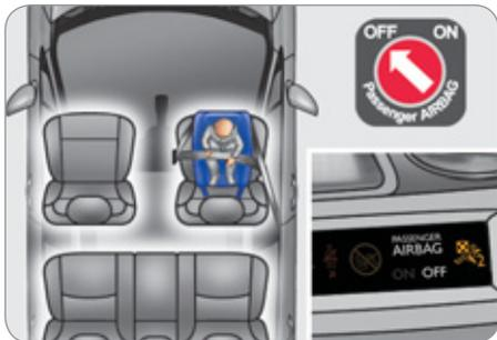
Wenn ein Kindersitz entgegen der Fahrtrichtung auf dem **Beifahrersitz vorne** eingebaut wird, muss der Sitz des Fahrzeugs in die mittlere Längsposition, in hoher Position und mit gerader Rückenlehne eingestellt werden.
