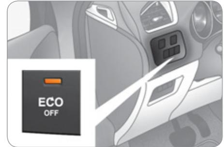
Sie können das System jederzeit durch Drücken der Taste "ECO OFF" deaktivieren; die Kontrollleuchte der Taste leuchtet auf.
