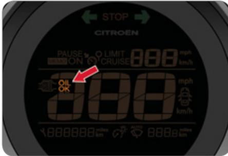
Beim Einschalten der Zündung wird zusammen mit der Wartungsinformation für die Dauer einiger Sekunden der Motorölstand angezeigt.
