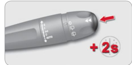
☞ Wenn die gewünschte Strecke angezeigt wird, drücken Sie länger als zwei Sekunden auf die Taste am Ende des **Scheibenwischerschalters**.
