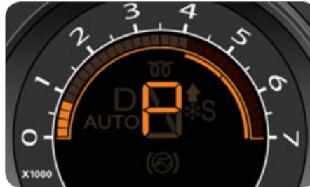
Der gewählte Fahrmodus und/oder der eingelegte Gang erscheinen in der linken Anzeige des Kombiinstrumentes.
