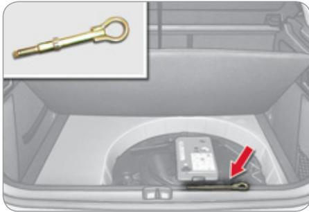
Die Abschleppöse befindet sich unter dem Bodenbelag im Kofferraum.
