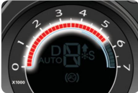
Bei Annäherung an die maximale Drehzahl leuchten die Segmente rot und blinken, um Ihnen anzuzeigen, dass Sie den nächsthöheren Gang einlegen müssen.
