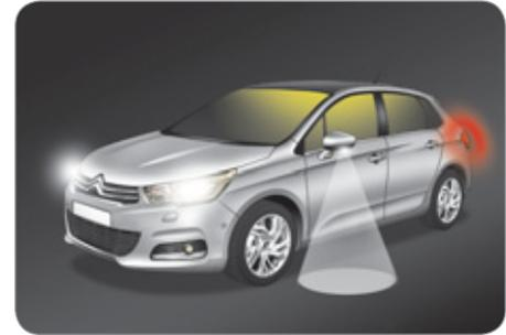
Bei schwachen Lichtverhältnissen, wahrgenommen durch den Helligkeitssensor, erleichtert Ihnen das Einschalten des Abblend- und Standlichts sowie der seitlichen Außenleuchten per Fernbedienung den Zugang zum Fahrzeug.
