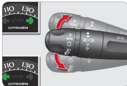
Drücken Sie den Lichtschalterhebel über den Widerstand hinaus nach oben oder nach unten; die entsprechenden Fahrtrichtungsanzeiger blinken bis der Hebel in die Ausgangsstellung zurückkehrt.
