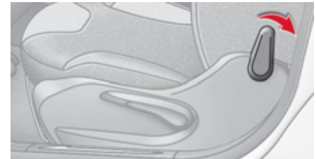
3. Verstellung der Lehne in der Neigung
