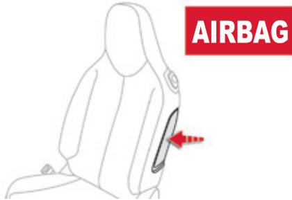
System, das Fahrer und Beifahrer bei einem starken Seitenaufprall Schutz bietet und die Verletzungsgefahr im Brustbereich sowie zwischen Hüfte und Schulter einschränken soll.
