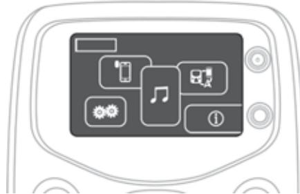
**i** Bei längerer Sonneneinstrahlung und bei sehr starker Hitze kann das System in Standby übergehen, um es zu schützen (Bildschirm und Ton erlöschen komplett), für eine minimale Dauer von 5 Minuten. Das System kehrt zum Normalzustand zurück, sobald die Temperatur im Fahrgastinnenraum sinkt.
