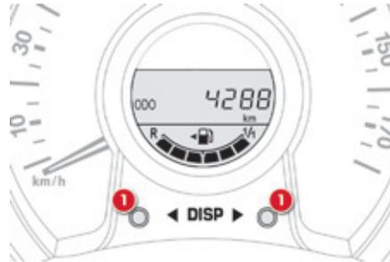
Durch Druck auf eine der Tasten 1 lässt sich die Kilometeranzeige wechseln:
