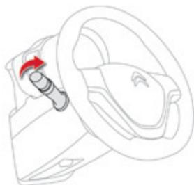
In dieser Funktion bleibt das Abblendlicht noch kurze Zeit nach dem Abstellen der Zündung eingeschaltet, um den Insassen bei geringer Helligkeit das Aussteigen zu erleichtern.
