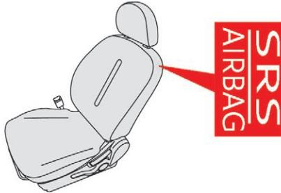
Dieses System bietet Fahrer und Beifahrer bei einem starken Seitenaufprall Schutz und soll die Verletzungsgefahr im Brustbereich sowie zwischen Hüfte und Schulter einschränken. Jeder Seiten-Airbag ist in das Sitzlehngestell an der Türseite integriert.
