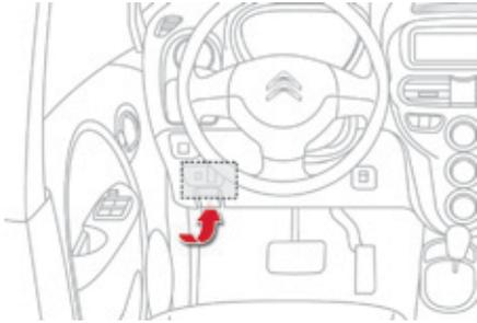
Die Zange zum Abziehen der Sicherungen ist an der Deckelrückseite des Sicherungskastens am Armaturenbrett (linke Seite) angebracht.
