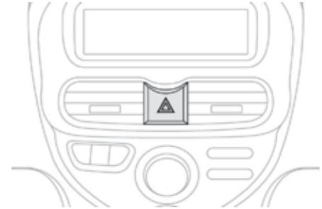
Gleichzeitiges Aufleuchten der Blinker, um andere Verkehrsteilnehmer bei einer Panne, beim Abschleppen oder bei einem Unfall zu warnen.
