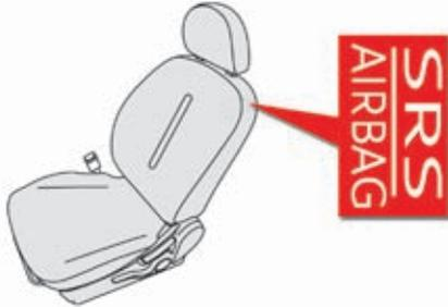
System, das Fahrer und Beifahrer bei einem starken Seitenaufprall Schutz bietet und die Verletzungsgefahr im Brustbereich sowie zwischen Hüfte und Schulter einschränken soll.
