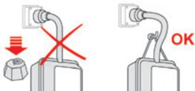
! Verwenden Sie die mitgelieferte Schnur zur Befestigung des Kontrollkästchens, damit dies nicht auf die Steckdose drückt (Gefahr der Beschädigung des Ladekabels oder der Steckdose).
