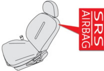
System, das Fahrer und Beifahrer bei einem starken Seitenaufprall Schutz bietet und die Verletzungsgefahr im Brustbereich sowie zwischen Hüfte und Schulter einschränken soll. Jeder Seitenairbag ist in das Sitzlehngestell an der Türseite integriert.
