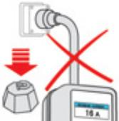
! Hängen Sie das Überwachungssteuergerät ein oder stellen Sie es auf, damit dieses nicht auf dem Netzanschluss lastet.
