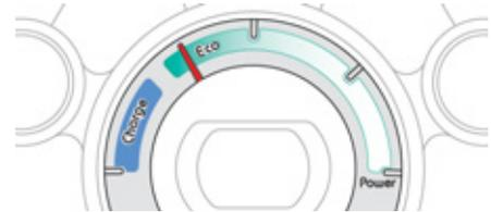
Der Zeiger befindet sich in diesem Bereich, wenn das Fahrzeug so genutzt wird, dass der Stromverbrauch gesenkt und die Reichweite optimiert wird.
