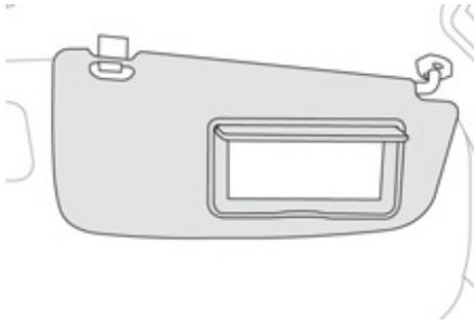
Die Sonnenblenden werden nach vorn herunter geklappt. Wenn man sie aushängt, können sie auch zur Seite geklappt werden. Sie sind mit einem Make-up-Spiegel und einem Kartenhalter ausgestattet.
