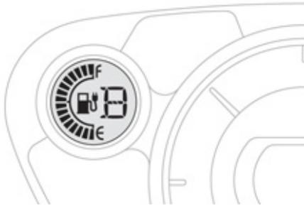
Der Ladezustand der Hauptbatterie wird dauerhaft im Kombiinstrument angezeigt.
