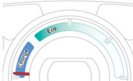
**Verwenden Sie den Bereich "Laden"** der Anzeige Energieverbrauch/Energieerzeugung so früh wie möglich: fahren Sie vorausschauend, d.h. bremsen Sie frühzeitig ab und - wenn es die Situation erlaubt - nehmen Sie lieber den Fuß vom Gas und lassen Sie das Fahrzeug langsamer werden, als dass Sie abrupt abbremsen.
