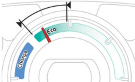
**Fahren Sie vor allem innerhalb des ECO-Bereichs**, der auf dem Leistungsmesser angegeben ist: Beschleunigen Sie moderat und fahren Sie möglichst bei konstanter Geschwindigkeit, indem Sie so oft wie möglich den Geschwindigkeitsbegrenzer bzw. den Geschwindigkeitsregler nutzen.
