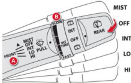
Die Scheibenwischer werden vom Fahrer mit dem Hebel **A** und dem Ring **B** betätigt.
