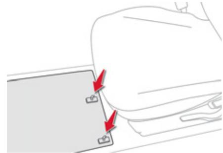
Schieben Sie zum Entfernen des Teppichschoners auf der Fahrerseite den Sitz so weit wie möglich zurück und entfernen Sie die Befestigungen. Richten Sie beim Wiederanbringen den Teppichschoner nach den Stiften aus und lassen Sie die Befestigungen einrasten. Vergewissern Sie sich, dass der Teppichschoner richtig fixiert ist.
