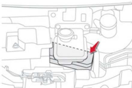
Der Sicherungskasten befindet sich im Raum unter der vorderen Haube unter dem Flüssigkeitsbehälter des Heizungssystems. Nur diese Sicherungen können ausgetauscht werden.
