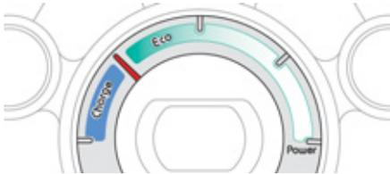
Bei Einschalten der Zündung wird über die elektrische Antriebskette Ihres Fahrzeugs weder Energie verbraucht noch erzeugt: Der Zeiger befindet sich in Position "neutral" (unter Vorbehalt, dass Heizung und Klimaanlage ausgeschaltet sind).
