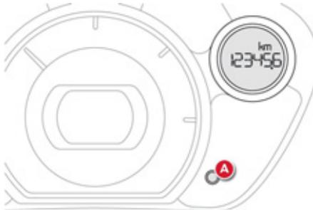
Instrument zur Messung der Gesamtkilometerleistung des Fahrzeugs während seiner Lebensdauer.
