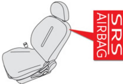
System, das Fahrer und Beifahrer bei einem starken Seitenaufprall Schutz bietet und die Verletzungsgefahr im Brustbereich sowie zwischen Hüfte und Schulter einschränken soll. Jeder Seitenairbag ist in das Sitzlehnenstell an der Türseite integriert.
