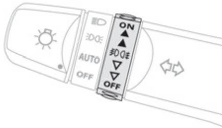
Ring zum Einschalten der Nebelleuchten. Sie funktionieren zusammen mit Stand-, Abblend- und Fernlicht.
