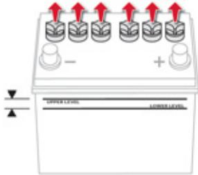
Um diesen Füllstand zu kontrollieren, müssen Sie die Schutzabdeckung der Batterie entfernen (siehe Abschnitt "Batterie für Zubehör").
