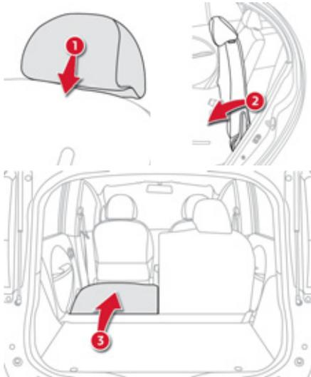
1. Schieben Sie die Kopfstützen nach unten oder ziehen Sie sie gegebenenfalls heraus.
