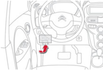
Die Zange zum Abziehen der Sicherungen ist an der Deckelrückseite des Sicherungskastens am Armaturenbrett (linke Seite) angebracht. Zugang:
