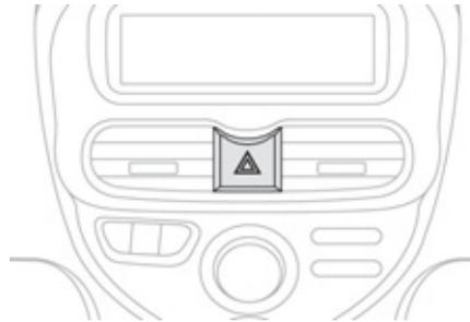
Gleichzeitiges Aufleuchten der Blinker, um andere Verkehrsteilnehmer bei einer Panne, beim Abschleppen oder bei einem Unfall zu warnen.
