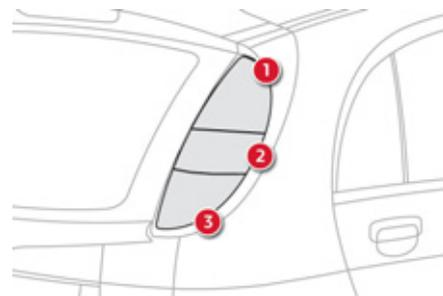
1. Bremsleuchten/Standleuchten (Dioden)
