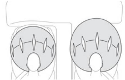
System, das bei einem starken Frontalaufprall Fahrer und Beifahrer schützt und die Verletzungsgefahr an Kopf und Oberkörper vermindert.
