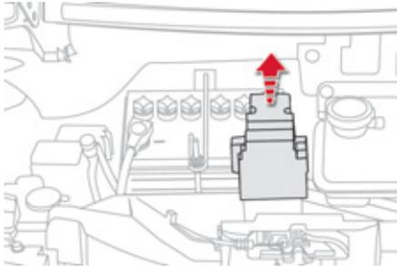
! Vergewissern Sie sich, dass die Elektrolyte nicht gefroren sind. Überprüfen Sie den Füllstand und fügen Sie gegebenenfalls destilliertes Wasser hinzu (siehe Abschnitt "Füllstandskontrollen" dieser Anleitung).
