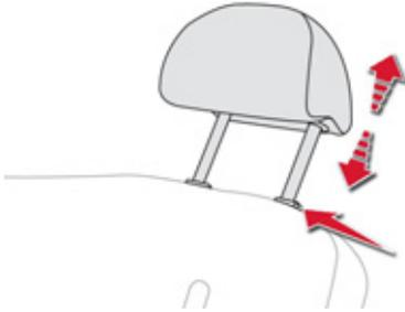
Die Kopfstützen verfügen über zwei Einstellpositionen: hoch (Komfort und mehr Sicherheit) und tief (bessere Sicht nach hinten für den Fahrer).
