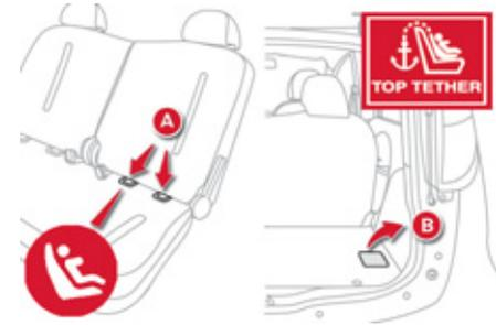
Mithilfe der zwei Ösen **A**, die sich zwischen Rückenlehne und Fahrzeugsitz befinden, kann ein ISOFIX-Kindersitz befestigt werden. Die Öse **B** ermöglicht die Befestigung des oberen Gurtes, dem sogenannten **TOP TETHER**.
