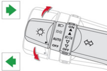
Mit dem Fahrtrichtungsanzeiger wird der Blinker links oder rechts gesetzt, um einen Richtungswechsel des Fahrzeugs anzuzeigen.
