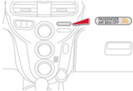
Diese Kontrollleuchte leuchtet auf der Mittelkonsole bei eingeschalteter Zündung auf und solange der Beifahrerairbag deaktiviert ist.
