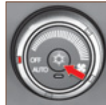
Inaktivierung der Klimaanlage
