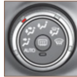
Regelung der Luftverteilung
