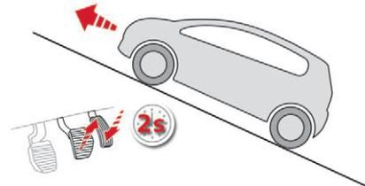
**Bergauf** wird das stehende Fahrzeug kurzzeitig angehalten, wenn das Bremspedal gelöst wird.
