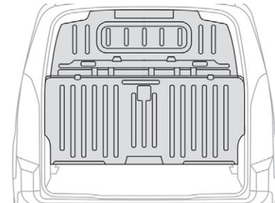
Auf dem Boden hinter den Vordersitzen schützt eine vertikale Trennwand Fahrer und Beifahrer beim Verrutschen der Ladung. Stahl- oder Glastrennwände trennen den Ladebereich von der Fahrerkabine.
