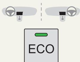
☞ Drücken Sie diese Taste, um diesen Modus zu deaktivieren oder zu aktivieren. Die Kontrollleuchte leuchtet auf, wenn das System aktiviert wird.
