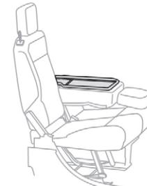
Die Rückenlehne des mittleren Rücksitzes kann zu einer Arbeitsoberfläche und somit zu einem mobilen Büro umgeklappt werden (bei stehendem Fahrzeug).
