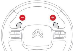
☞ Ziehen Sie am Schalter rechts „+“, um hochzuschalten, oder am Schalter links „-“, um herunterzuschalten.
