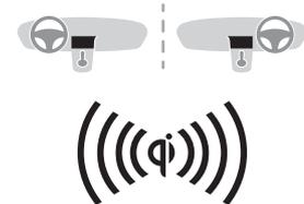
Mit diesem System können tragbare Geräte wie Smartphones kabellos geladen werden, indem das Prinzip der magnetischen Induktion gemäß der Norm Qi 1.1 genutzt wird. Das aufzuladende Gerät muss mit der Norm Qi kompatibel sein, entweder durch seine Konzipierung oder mithilfe eines kompatiblen Etuis bzw. einer kompatiblen Hülle. Der Ladebereich wird durch das Symbol Qi angezeigt.
