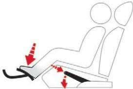
☞ Ziehen Sie mit dem Fuß auf der Bremse leicht am Hebel der Feststellbremse, drücken Sie auf den Entriegelungsknopf und drücken Sie den Hebel der Feststellbremse ganz nach unten.
