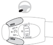
Mit dieser Taste kann eine Geschwindigkeitsstufe ausgewählt werden, um diese mit dem Geschwindigkeitsbegrenzer oder dem programmierbaren Geschwindigkeitsregler zu verwenden.
