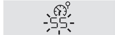
Der Begrenzer wird vorübergehend deaktiviert, auf dem Kombiinstrument wird die programmierte Geschwindigkeit angezeigt, die in diesem Fall jedoch blinkt.
