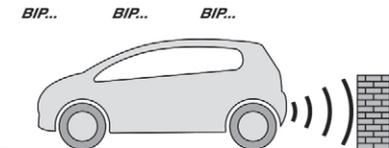
Die Funktion signalisiert das Vorhandensein von Hindernissen sowohl innerhalb des Sensorerkennungsbereichs als auch in der Fahrspur des Fahrzeugs, die durch die Ausrichtung des Lenkrads bestimmt wird.
