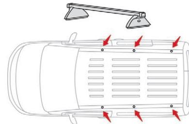
Benutzen Sie für die Montage von Querträgern oder einem Dachgepäckträger die dafür vorgesehenen Schnellbefestigungen:
