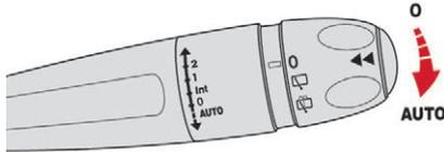
Wenn es regnet, werden die Scheibenwischer automatisch ohne Zutun des Fahrers betätigt (Sensor hinter dem Innenspiegel) und passen ihre Wischgeschwindigkeit an die Niederschlagsmenge an.
