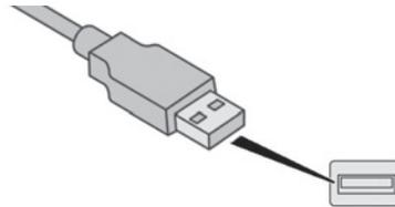
Stecken Sie den USB-Stick in den USB-Anschluss oder schließen Sie das USB-Gerät mithilfe eines nicht mitgelieferten passenden Kabels an den USB-Anschluss an. Das System geht automatisch zur Quelle „USB“ über.
