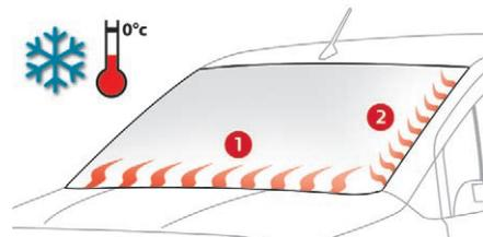
Im Bereich **1** taut die Heizung Schnee auf und löst die Scheibenwischer.
