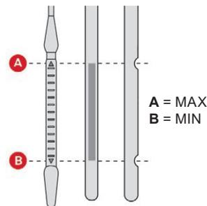
Wenn Sie feststellen, dass sich der Füllstand oberhalb der Markierung **A** oder unterhalb der Markierung **B** befindet, **starten Sie den Motor nicht**.
