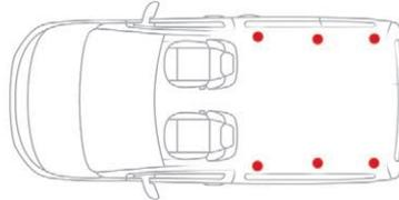
Nutzen Sie die Verzurrösen hinten am Boden, um das Ladegut zu sichern. Aus Gründen der Sicherheit bei starkem Abbremsen empfiehlt es sich, die schwersten Gegenstände weiter vorne zum Fahrerhaus hin zu verstauen. Es empfiehlt sich, die Ladung mit Hilfe der Ösen auf dem Boden festzuzurren, damit sie nicht verrutschen kann.
