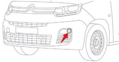
Wenn Ihr Fahrzeug entsprechend ausgestattet ist, sorgt diese Funktion bei eingeschaltetem Abblendlicht für eine Ausleuchtung der Kurveninnenseite durch den Lichtkegel der Nebelscheinwerfer, wenn die Geschwindigkeit des Fahrzeugs unter 40 km/h liegt (Stadtverkehr, kurvenreiche Straßen, Kreuzungen, Parkmanöver usw.).
