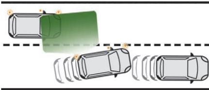
Bei betätigten Fahrtrichtungsanzeigern sowie für einige Sekunden, nachdem diese ausgeschaltet wurden, geht das System davon aus, dass das Verlassen der Fahrspur beabsichtigt ist, und löst daher während dieses Zeitraums keine Richtungskorrektur aus.
