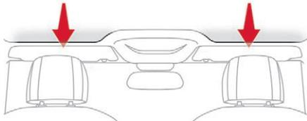
Sie befindet sich oberhalb der Sonnenblenden und ermöglicht das Verstauen verschiedener Gegenstände.
