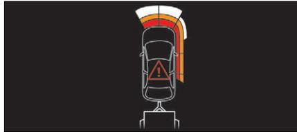
i Die Funktion der Einparkhilfe hinten wird bei Montage eines Anhängers oder Fahrradträgers auf der Anhängerkupplung (bei Fahrzeugen mit nach Herstellervorgaben montierter Anhängerkupplung) automatisch deaktiviert. In diesem Fall wird der Umriss eines Anhängers hinter dem Bild des Fahrzeugs angezeigt.
