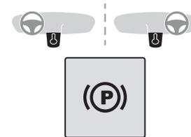
Der Fahrer kann jederzeit eingreifen, um die Feststellbremse mit dem Betätigungsschalter zu lösen oder anzuziehen:
