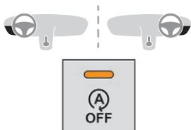
☞ Drücken Sie diese Taste, um das System zu deaktivieren oder erneut zu aktivieren. Die Kontrollleuchte **leuchtet auf**, wenn das System **deaktiviert** wird.
