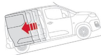
Seien Sie beim Öffnen vorsichtig, wenn das Fahrzeug mit dem Frontteil nach oben an einem Hang steht. Die Tür könnte sich aufgrund des Gefälles schneller öffnen. Im Falle eines starken Gefälles müssen Sie die Seitentür manuell begleiten, um beim Schließen zu helfen.
