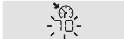
Der Regler wird vorübergehend deaktiviert und die programmierte Geschwindigkeit blinkt auf der Anzeige. Um zur programmierten Geschwindigkeit zurückzukehren, genügt es, das Gaspedal wieder loszulassen.
