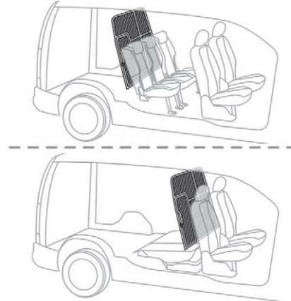
Eine bewegliche Trennwand, die hinter den Sitzen der Reihe 2 oder Reihe 1 eingesetzt werden kann, schützt Fahrer und Insassen vor verrutschender Ladung.
