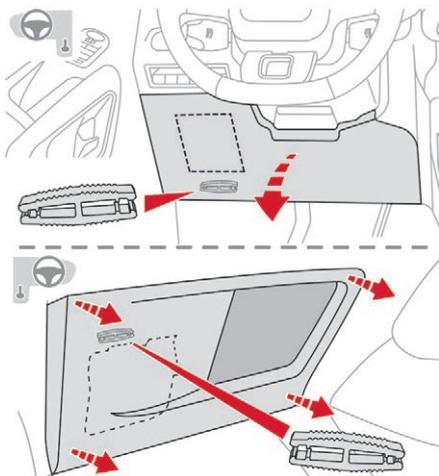
Die Zange zum Abziehen der Sicherungen befindet sich hinter dem Deckel des Sicherungskastens.
