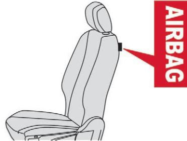
Wenn Ihr Fahrzeug damit ausgestattet ist, schützt dieses System Fahrer und Beifahrer bei einem starken Seitenaufprall, um die Verletzungsgefahr im Bauchbereich sowie am Kopf einzuschränken. Jeder Seiten-Airbag ist in das Sitzlehngestell an der Türseite integriert.
