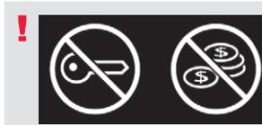
Lassen Sie während des Ladevorgangs keine metallischen Gegenstände (Münzen, Schlüssel, Fernbedienung des Fahrzeugs usw.) im Ladebereich liegen. Gefahr der Überhitzung oder der Unterbrechung des Ladevorgangs!
