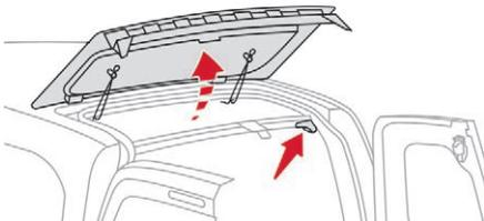
Öffnen der Dachklappe hinten:
