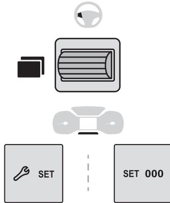
Verwenden Sie **bei stehendem Fahrzeug** den linken Drehregler am Lenkrad oder die Taste „SET“ im Kombiinstrument, um durch die Menüs zu navigieren und bestimmte Fahrzeugeinstellungen vorzunehmen.
