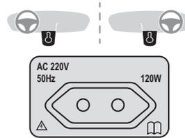
Ein 220V/50-Hz-Anschluss (maximale Leistungsaufnahme: 120 W) befindet sich in der Mittelkonsole.
