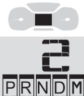
Wenn Sie das Gangwahrad verstellen oder auf die Taste **M** drücken, leuchtet die entsprechende Kontrollleuchte auf dem Kombiinstrument auf.
