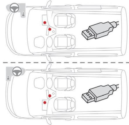
An diese Anschlüsse kann ein mobiles Gerät zum Aufladen angeschlossen werden, z.B. ein digitaler Audioplayer ähnlich einem iPod®.
