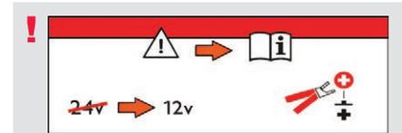
Bei Vorhandensein dieses Aufklebers ist ausschließlich ein 12V-Ladegerät zu verwenden, um irreparable Schäden am STOP & START-System zu vermeiden.
