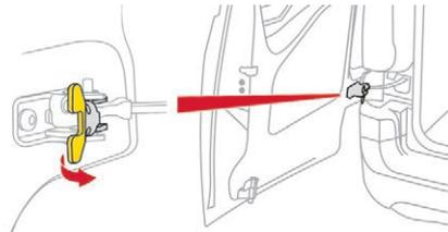
Wenn Ihr Fahrzeug mit dieser Vorrichtung ausgerüstet ist, lässt sich die Türöffnung mit Hilfe einer versenkbaren Federspanne von etwa 90° auf etwa 180° erweitern.
