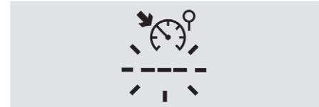
Das Blinken der Striche weist auf eine Funktionsstörung des Geschwindigkeitsreglers hin.
