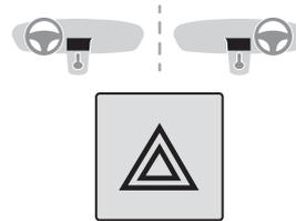
Durch Drücken dieses roten Schalters beginnen alle vier Fahrtrichtungsanzeiger zu blinken. Er funktioniert auch bei ausgeschalteter Zündung.
