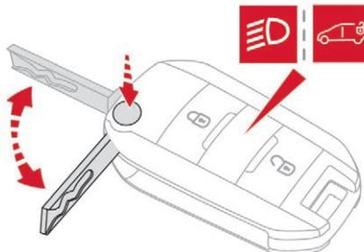
☞ Drücken Sie auf diese Taste, um den Schlüssel aus-/einzuklappen.
