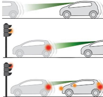
Diese Funktion, die auch als automatischer Bremsassistent bezeichnet wird, greift nach den Warnungen ein, wenn der Fahrer nicht schnell genug reagiert und das Bremspedal des Fahrzeugs nicht betätigt. Ziel dieser Funktion ist, im Fall des Nichteingriffs des Fahrers die Aufprallgeschwindigkeit zu verringern bzw. den Frontalaufprall Ihres Fahrzeugs zu verhindern.
