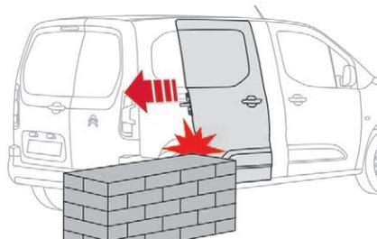
In geöffnetem Zustand steht die Tür über. Bitte beachten Sie dies, wenn Sie Ihr Fahrzeug an einer Mauer, einem Pfosten, einem erhöhten Bordstein usw. parken.
