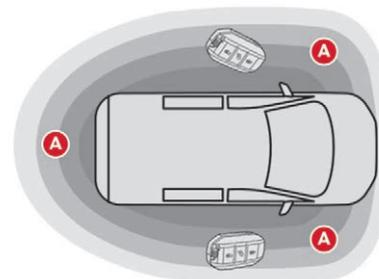
System, mit dem sich das Fahrzeug entriegeln, verriegeln und starten lässt, indem man die Fernbedienung bei sich trägt.
