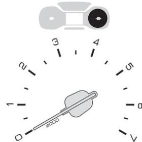
Drehzahlmesser (x 1 000 U/min oder rpm)
