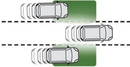
Dieses Fahrerassistenzsystem informiert den Fahrer, wenn sich ein herannahendes Fahrzeug im toten Winkel (Bereich außerhalb des Sichtfelds des Fahrers) seines Fahrzeugs befindet, sobald dies eine mögliche Gefahr darstellt.
