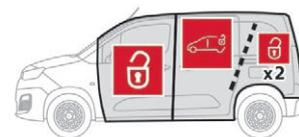
Mit der Einzelentriegelung können entweder die Türen des **Fahrerhauses** oder die Türen des **Ladebereichs** (seitlich und hinten) geöffnet werden.
