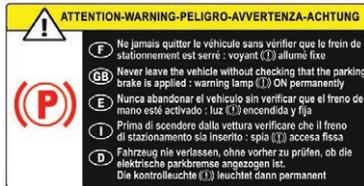
**!** Bitte stellen Sie vor Verlassen des Fahrzeuges sicher, dass die Feststellbremse angezogen ist: die Kontrollleuchten der Feststellbremse müssen im Kombiinstrument und am Betätigungsschalter ununterbrochen leuchten.
