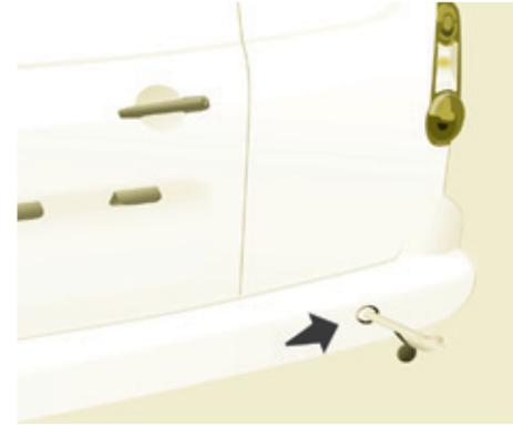
**i** Beim Abschleppen mit abgestelltem Motor sind Bremskraftverstärkung und Servolenkung nicht mehr wirksam.
