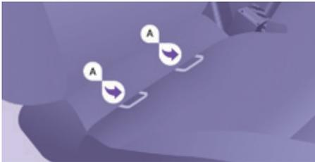
Zwei vordere Ösen **A** zwischen Lehne und Sitzfläche des Fahrzeugsitzes, gekennzeichnet durch eine Markierung.
