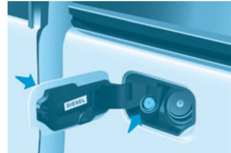
Die BlueHDI-Fahrzeuge sind mit einem speziellen Tank ausgestattet, dem AdBlue®-Tank, der ein **Fassungsvermögen von 17 Litern** hat.
