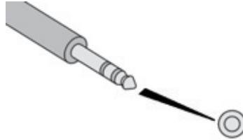
Schließen Sie das mobile Abspielgerät (MP3-Player, ...), mit Hilfe eines Audiokabels (nicht mitgeliefert), an den Cinch-Anschluss an.
