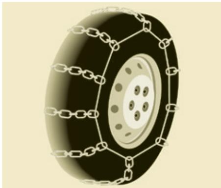
**i** Die Schneeketten dürfen nur auf die Antriebsräder montiert werden. Sie dürfen nicht auf Noträdern montiert werden.
