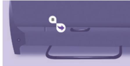
Eine hintere Öse **B** auf der Rückseite der Fahrzeugsitzlehne zur Befestigung des oberen Gurts, der sogenannten Top Tether-Verankerung.
