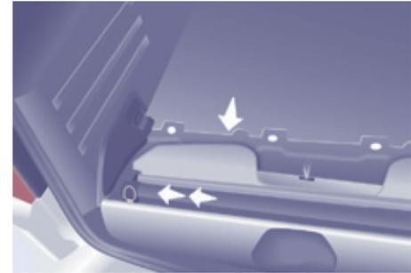
Die Öffnung an der Kofferraumladekante ist für die Aufnahme der Gurtwickelrolle einschließlich Gepäckraumabdeckung vorgesehen.
