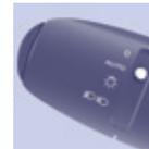
Um die Nachleuchtfunktion zu aktivieren, drehen Sie diesen Ring in Position "0", Leuchten ausgeschaltet, und drehen Sie anschließend den Ring in die gewünschte Richtung.
