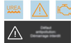
Bei jedem Anlassversuch wird die Warnung aktiviert und die Meldung "Fehler Abgasreinigung: Anlasser gesperrt" angezeigt.
