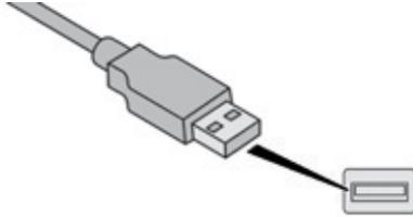
Stecken Sie den USB-Stick in den USB-Anschluss oder schließen Sie das USB-Gerät mit Hilfe eines nicht mitgelieferten passenden Kabels an den USB-Anschluss an.
