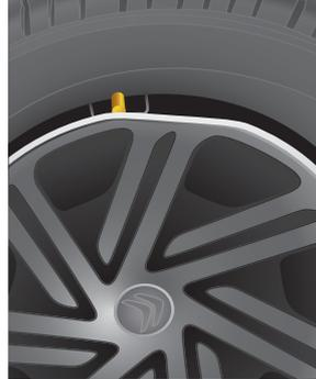
Verformung des Zierkappenrandes auf Höhe des Ventils, aufgrund falscher Montage.
