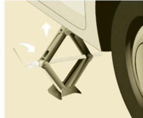
Achten Sie darauf, dass der Wagenheber mit der Sohle fest auf dem Boden und stabil steht.
