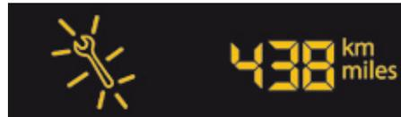
Ein paar Sekunden nach dem Einschalten der Zündung wird der Ölstand je nach Ausführung angezeigt, anschließend nimmt der Kilometerzähler seine normale Funktion wieder auf, der Schlüssel bleibt jedoch erleuchtet. Er weist darauf hin, dass in Kürze eine Wartung fällig ist.
