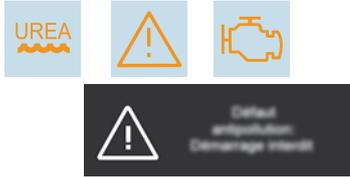
Bei jedem Einschalten der Zündung leuchten die Kontrollleuchten für SERVICE und Motorselbstdiagnose, die Kontrollleuchte UREA blinkt, es ertönt ein Warnsignal und die Meldung "Fehler Abgasreinigung: Anlasser gesperrt" wird angezeigt.
