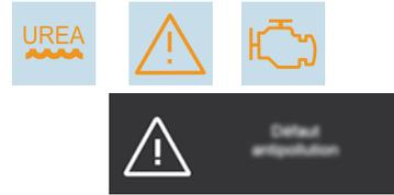
Beim Einschalten der Zündung leuchten die Kontrollleuchten für SERVICE, UREA und Motorselfdiagnose, es ertönt ein Warnsignal und die Meldung "Fehler Abgasreinigung" zeigt einen Emissionsfehler an.
