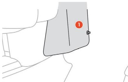
Entfernen Sie die Mutter der Zugangsklappe (1), die sich unter dem Ablagefach auf der Beifahrerseite befindet.
