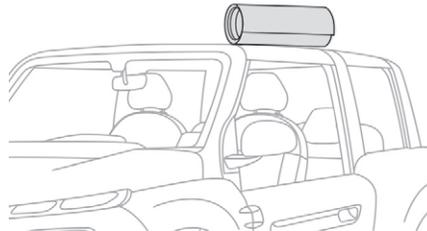
Platzieren Sie das Dachelement auf einer der Seiten des Fahrzeugs.
