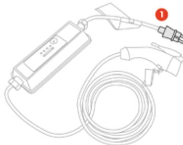
1. Schließen Sie den Stecker (1) an einen 230V/10 A-Netzsteckanschluss oder 16 A-Ladestation für Elektroautos an. Alle LEDs des Steuergeräts leuchten etwa ½ Sekunde auf, anschließend leuchtet die grüne Betriebs-LED POWER ununterbrochen.
