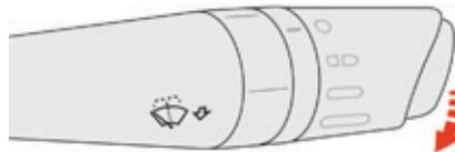
Funktionsweise der Scheibenwaschanlage: ziehen Sie den Scheibenwischerschalter zu sich heran. Diese Betätigung aktiviert automatisch den Scheibenwischer vorne und spritzt Reinigungsmittel auf die Scheibe.
