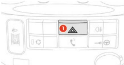
Drücken Sie auf die Betätigungstaste **(1)** der Warnblinkanlage, um den anderen Verkehrsteilnehmern anzuzeigen, dass Sie sich in einer besonderen Fahr- oder Verkehrssituation befinden bzw. gezwungen sind, an einer ungewöhnlichen Stelle zu halten.
