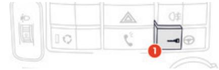
Um die Kofferraum-Bodenklappe Ihres E-MEHARI manuell von innen zu ver- oder entriegeln: drücken Sie auf den Betätigungsschalter (1).
