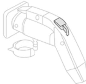
1. Drücken Sie den Entriegelungsknopf an der Oberseite des Steckverbinders und ziehen Sie das Kabel ab. Die Ladepistole lässt sich nur abtrennen, wenn Ihr E-MEHARI zuvor mit dem persönlichen RFID-Schlüsselanhänger entriegelt wurde.
