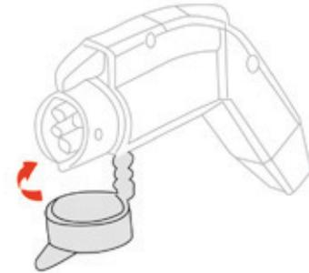
2. Setzen Sie den Schutzdeckel auf die Pistole.
