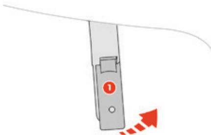
1. Entriegelung der Motorhaube: Ziehen Sie zum Öffnen der Motorhaube an Hebel (1), der sich links unter dem Lenkrad, auf Höhe des linken Vorderreifens des Fahrzeugs befindet.
