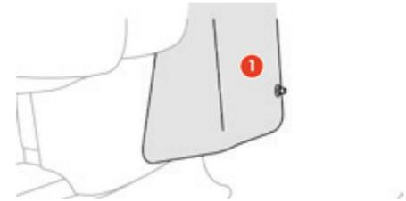
Entfernen Sie die Mutter der Zugangsklappe (1), die sich unter dem Ablagefach auf der Beifahrerseite befindet.
