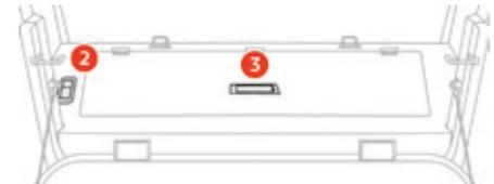
Um die Kofferraum-Bodenklappe zu öffnen: ziehen Sie an der Öffnungsbetätigung (2) und heben Sie die Klappe dann mit dem Griff (3) an.
