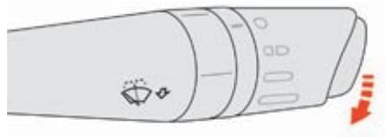
Funktionsweise der Scheibenwaschanlage: ziehen Sie den Scheibenwischerschalter zu sich heran. Diese Betätigung aktiviert automatisch den Scheibenwischer vorne und spritzt Reinigungsmittel auf die Scheibe.
