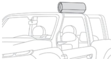
Platzieren Sie das Dachelement auf einer der Seiten des Fahrzeugs.
