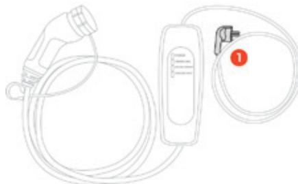
1. Schließen Sie den Stecker (1) an einen 230V-Anschluss mit max. 10 A Wechselstrom an. Alle LEDs des Steuergeräts leuchten etwa ½ Sekunde auf, anschließend leuchtet die Betriebs-LED POWER ununterbrochen.
