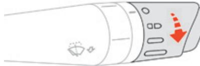
Um den Scheibenwischer zu aktivieren: drehen Sie den Ring am Betätigungsschalter rechts hinter dem Lenkrad.
