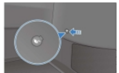
Von der Ladestation abtrennen (Notfallfreigabe)
