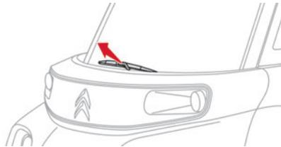
**!** Achten Sie darauf, die Arme nicht in der Nähe der Düsen zu halten. Berühren Sie das Wischerblatt nicht. Es könnte bleibend beschädigt werden. Lassen Sie es bei der Handhabung nicht los. Es besteht die Gefahr, die Windschutzscheibe zu beschädigen.
