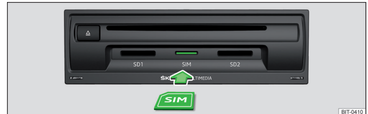
Abb. 27 Externes Modul - Einstecken der SIM-Karte
