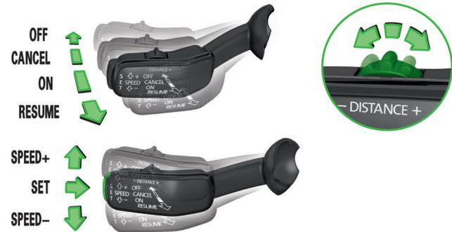
Die automatische Distanzregelung regelt die eingestellte Geschwindigkeit und den Abstand zu vorausfahrenden Fahrzeugen, ohne dass das Gas- oder Bremspedal betätigt werden muss.
