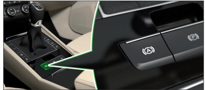
Die Auto Hold Funktion sichert das Fahrzeug beim Anhalten gegen Wegrollen. Die Sicherung des Fahrzeugs wird durch Aufleuchten der Kontrollleuchte (A) im Kombi-Instrument angezeigt.
