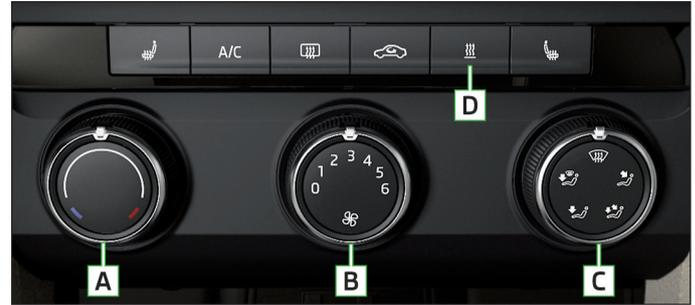
Einzelne Funktionen lassen sich durch Drehen des Drehreglers oder Drücken der jeweiligen Taste einstellen bzw. einschalten. Bei eingeschalteter Funktion leuchtet unterhalb der Taste die Kontrollleuchte.
