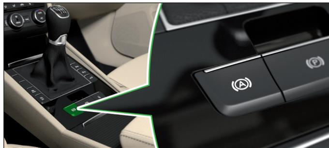
Die Auto Hold Funktion sichert das Fahrzeug beim Anhalten gegen Wegrollen. Die Sicherung des Fahrzeugs wird durch Aufleuchten der Kontrollleuchte
