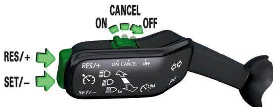
Die Geschwindigkeitsregelanlage regelt die eingestellte Geschwindigkeit, ohne dass das Gaspedal betätigt werden muss. Während der Regelung leuchtet im Kombi-Instrument die Kontrollleuchte
