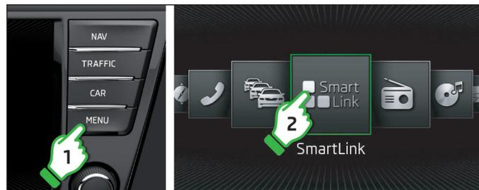
Die SmartLink-Funktion bietet die Möglichkeit an, die im unterstützten angeschlossenen Gerät (z. B. Telefon) zertifizierten Anwendungen im Gerätebildschirm anzuzeigen und zu bedienen.
