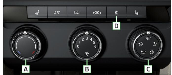
Einzelne Funktionen lassen sich durch Drehen des Drehreglers oder Drücken der jeweiligen Taste einstellen bzw. einschalten. Bei eingeschalteter Funktion leuchtet unterhalb der Taste die Kontrollleuchte.
