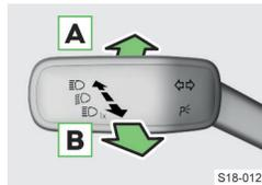
**A** Fernlicht einschalten - im Kombi-Instrument leuchtet die Kontrollleuchte  $\odot$
