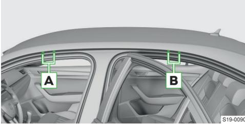
Die Dachquerträger können ausstattungsabhängig an den Befestigungspunkten **A** und **B** oder an der Dachreling befestigt werden.
