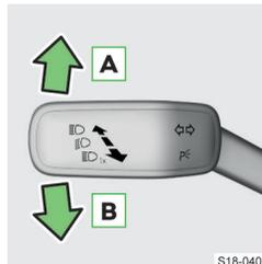
**A** Blinklicht rechts einschalten - im Kombi-Instrument blinkt die Kontrollleuchte  $\rightarrow$
