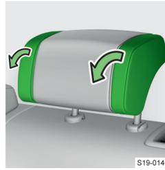
Die vorgeklappten Seitenwangen reduzieren eine unkontrollierte Kopfbewegung seitwärts, z. B. beim Schlafen.
