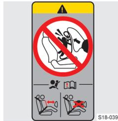
Aufkleber an der mittleren Karoseriesäule auf der Beifahrerseite.
