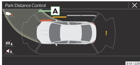
**A** Fahrweg, der beim aktuellen Lenkeinschlag angesteuert wird
