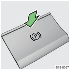
› Bei eingeschalteter Zündung das Bremspedal betätigen und gleichzeitig die Taste (P) drücken.
