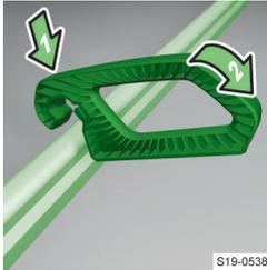
› Zum **Einsetzen** das Befestigungselement in Schrägrichtung auf die Trennwand stecken und nach unten drücken.
