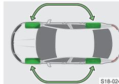
Zur gleichmäßigen Abnutzung der Reifen empfehlen wir, die Räder alle 10 000 km entsprechend dem Schema zu tauschen.
