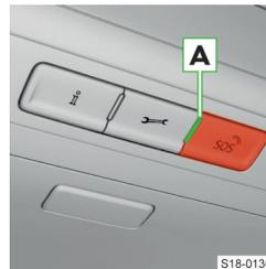
Der Systemzustand wird nach dem Einschalten der Zündung durch Aufleuchten der Kontrollleuchte **A** angezeigt.
