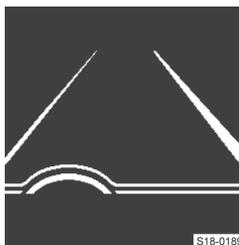
Fahrspurbegrenzung rechts hervorgehoben: System greift bei der Annäherung an die Begrenzungslinie rechts ein.
