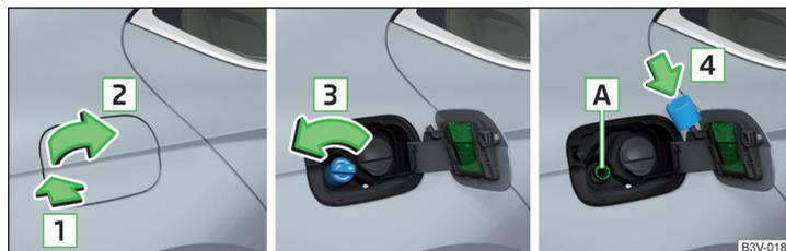
Abb. 316 Tankklappe aufklappen / Tankverschluss herausdrehen / Tankverschluss auf die Tankklappe stecken
