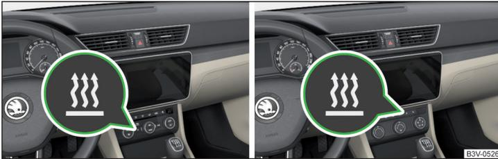
Abb. 174 Taste für das Ein-/Ausschalten (Climatronic / manuelle Klimaanlage)
