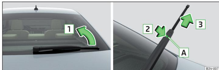
Abb. 354 Scheibenwischerblatt der Heckscheibe auswechseln
