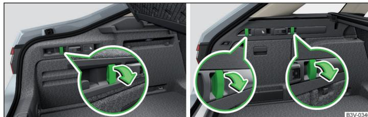
Abb. 143 Haken herunterklappen: Variante 1 / Variante 2
