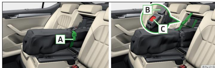
Abb. 128 Band anziehen / Sack sichern
