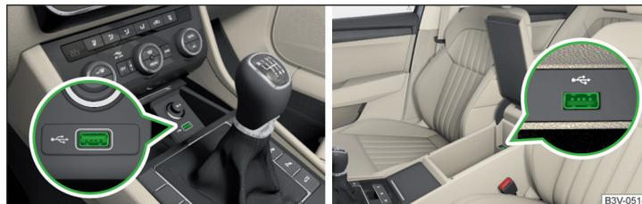
Abb. 110 USB-Eingang vorn / USB-Eingang unter der Armlehne
