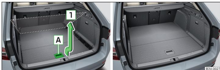
Abb. 159 Variablen Ladeboden in die obere Position einstellen / Variabler Ladeboden in der oberen Position
