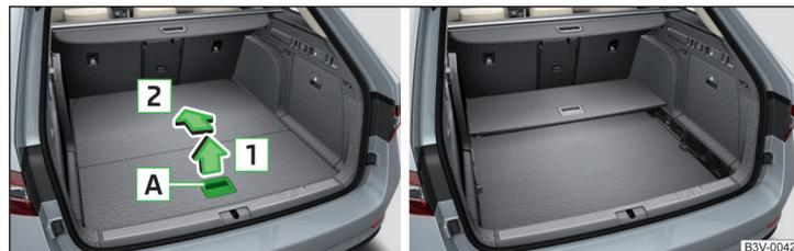
Abb. 161 Variablen Ladeboden zusammenklappen / Zusammengeklappter variabler Ladeboden in der oberen Position
