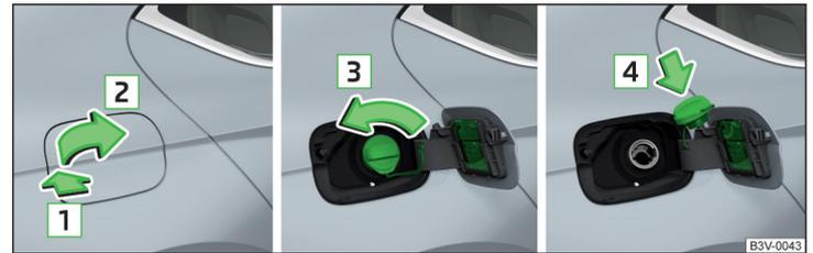
Abb. 314 Tankklappe aufklappen / Tankverschluss herausdrehen / Tankverschluss auf die Tankklappe stecken
