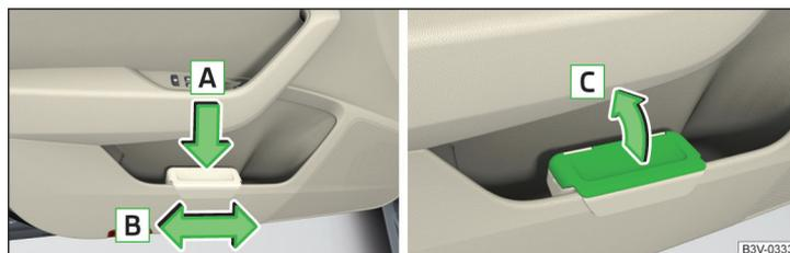
Abb. 114 Abfallbehälter: einsetzen und verschieben / öffnen
