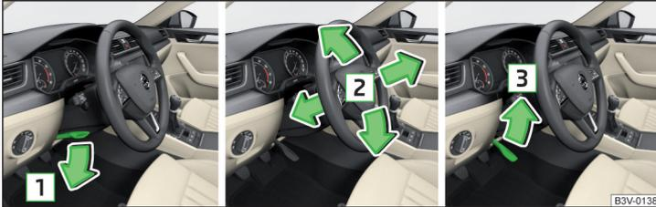
Abb. 16 Lenkradposition einstellen
