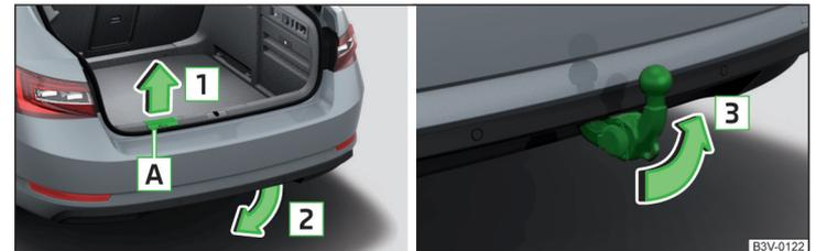
Abb. 310 Kugelstange: heraus-/einschwenken
