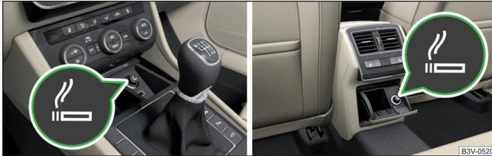
Abb. 134 Zigarettenanzünder: in der Mittelkonsole vorn / in der Mittelkonsole hinten
