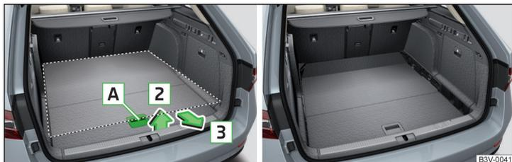
Abb. 160 Variablen Ladeboden in die untere Position einstellen / Variabler Ladeboden in der unteren Position
