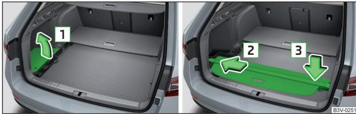
Abb. 149 Seitenabdeckung links abnehmen / Aufrollbare Abdeckung verstauen
