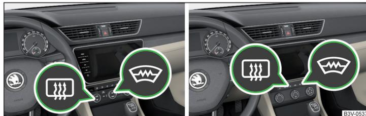
Abb. 77 Tasten für die Front- und Heckscheibenbeheizung: Climatronic / Manuelle Klimaanlage
