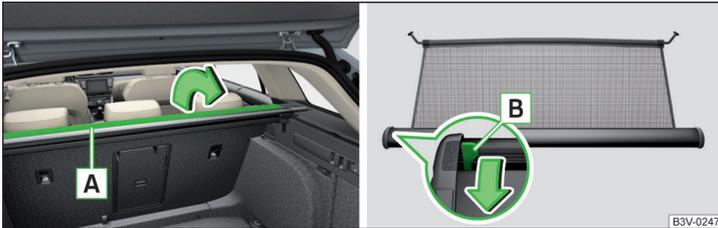
Abb. 163 Teil der aufrollbaren Gepäckraumabdeckung aufklappen / Entriegelungshebel
