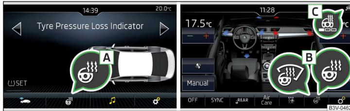
Abb. 104 Lenkradheizung: Manuelle Klimaanlage / Climatronic
