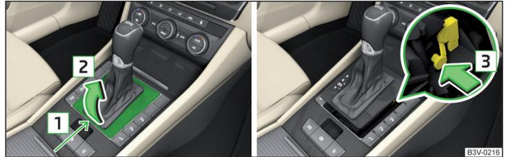
Abb. 351 Abdeckung abnehmen / Wählhebel entriegeln
