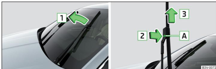
Abb. 353 Scheibenwischerblatt der Frontscheibe auswechseln
