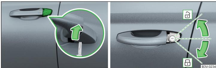
Abb. 347 Griff an der Fahrtür: Schlossabdeckung aufklappen / ent- und verriegeln
