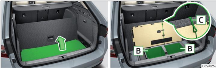
Abb. 154 Variante 2: Bodenbelag anheben / Ablagefächer
