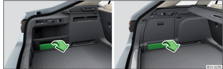
Abb. 151 Cargo-Elemente herausnehmen: Variante 1 / Variante 2
