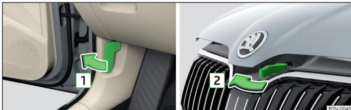
Abb. 317 Motorraumklappe öffnen
