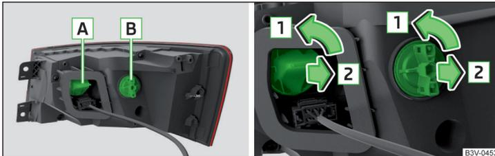
Abb. 367 Rückleuchte / Glühlampe wechseln
