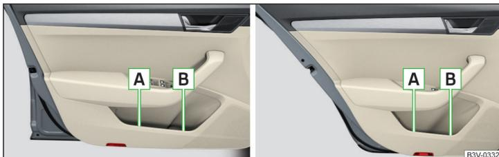
Abb. 107 Ablagefächer: in der vorderen Tür / in der hinteren Tür
