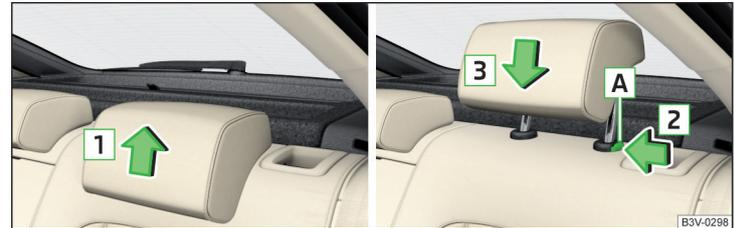
Abb. 97 Höhe der Kopfstütze hinten einstellen
