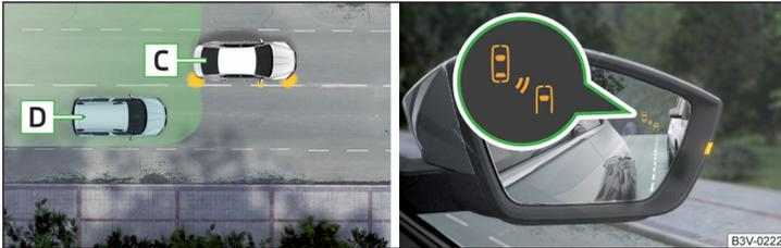
Abb. 278 Fahrsituation / Kontrollleuchte im rechten Außenspiegel weist auf die Fahrsituation hin
