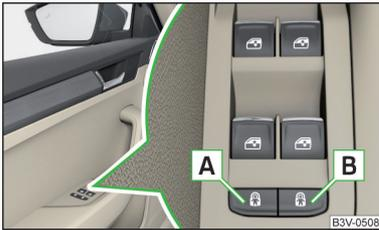
Abb. 56 Kindersicherung mit elektrischer Bedienung
