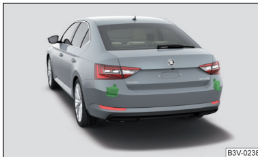
Abb. 273 Verbauter der Radarsensoren
