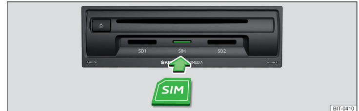
Abb. 207 SIM-Karte in das externe Modul einstecken
