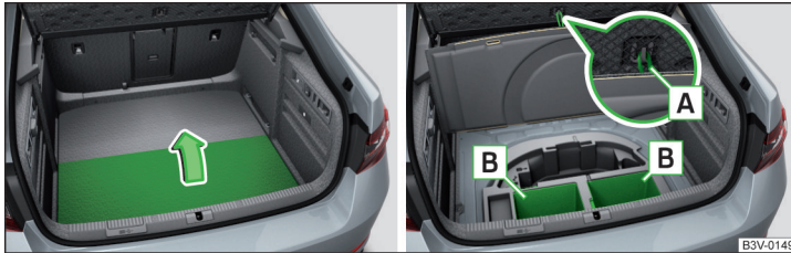
Abb. 151 Variante 1: Bodenbelag anheben / Ablagefächer
