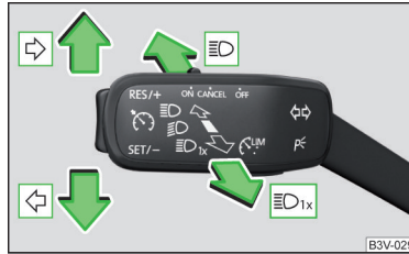
Abb. 67 Bedienungshebel: Blink- und Fernlichtbedienung
