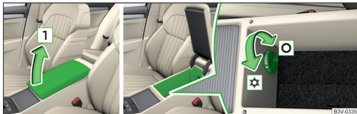
Abb. 114 Ablagefach öffnen / Luftzufuhr bedienen
