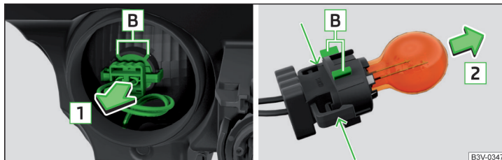
Abb. 368 Glühlampe für Blinklicht vorn wechseln
