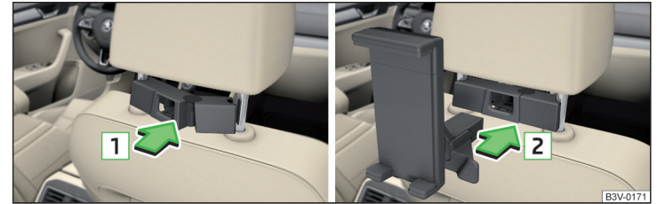
Abb. 134 Einsetzen: Adapter / Halter
