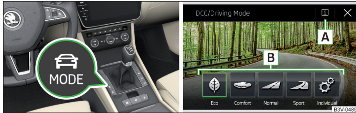
Abb. 306 Taste für die Auswahl des Fahrmodus / Anzeige im Infotainmentbildschirm
