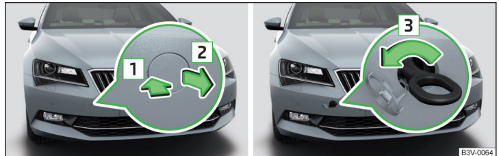
Abb. 345 Abdeckkappe abnehmen / Abschleppöse einbauen
