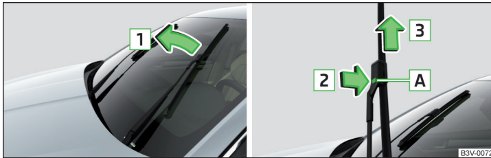
Abb. 358 Scheibenwischerblatt der Frontscheibe auswechseln
