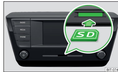
Abb. 202 Swing: SD-Karte einschieben
