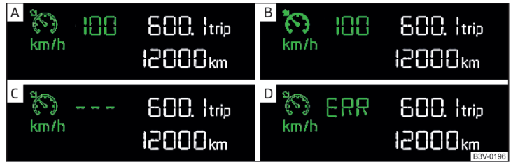
Abb. 292 Segmentdisplay: Beispiele für Zustandsanzeigen der GRA
