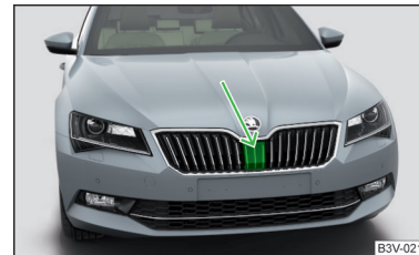
Abb. 268 Verbauort des Radarsensors
