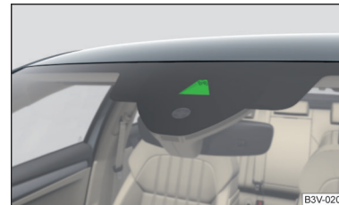
Abb. 71 Sensorsichtfenster für den Scheinwerferassistenten
