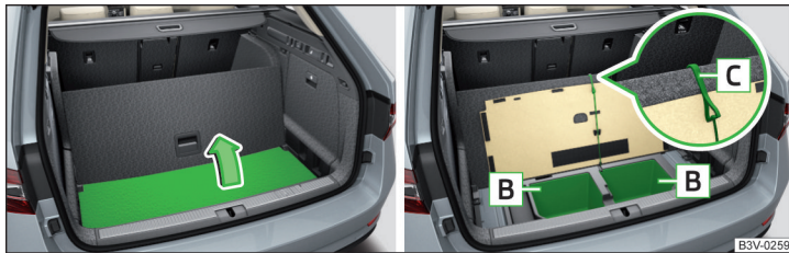
Abb. 153 Variante 2: Bodenbelag anheben / Ablagefächer
