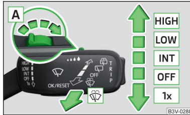
Abb. 81 Bedienung der Scheibenwisch- und Waschanlage vorn
