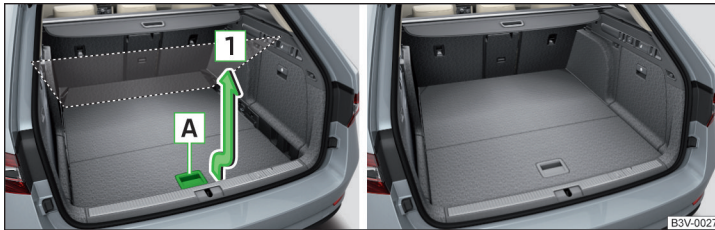
Abb. 158 Variablen Ladeboden in die obere Position einstellen / Variabler Ladeboden in der oberen Position
