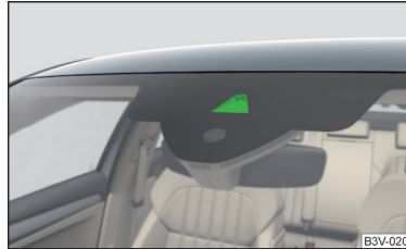
Abb. 307 Sensor für Lane Assist
