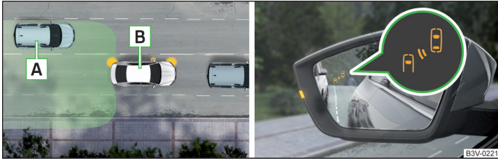
Abb. 277 Fahrsituation / Kontrollleuchte im linken Außenspiegel weist auf die Fahrsituation hin
