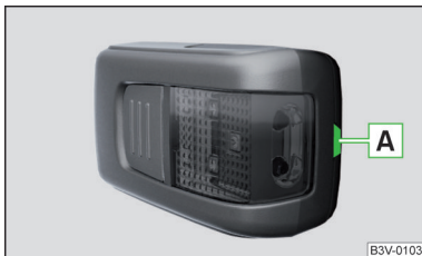
Abb. 351 Arretierungsclip an der Akkuabdeckung
