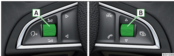
Abb. 47 Tasten/Einstellräder am Multifunktionslenkrad
