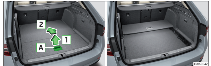
Abb. 160 Variablen Ladeboden zusammenklappen / Zusammengeklappter variabler Ladeboden in der oberen Position
