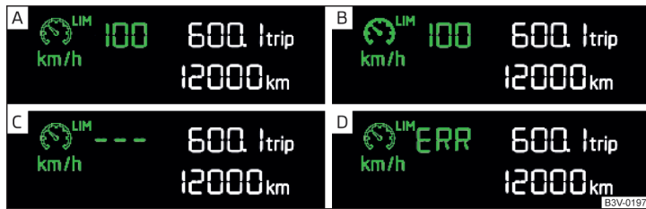
Abb. 295 Segmentdisplay: Beispiele für Zustandsanzeigen des Geschwindigkeitsbegrenzers
