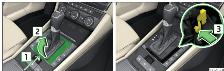
Abb. 356 Abdeckung abnehmen / Wählhebel entriegeln
