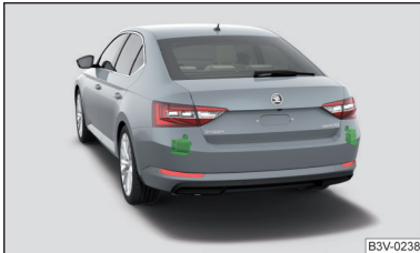
Abb. 275 Verbauort der Radarsensoren
