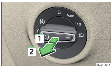
Abb. 69 Lichtschalter - Nebelscheinwerfer/Nebelschlussleuchte einschalten
