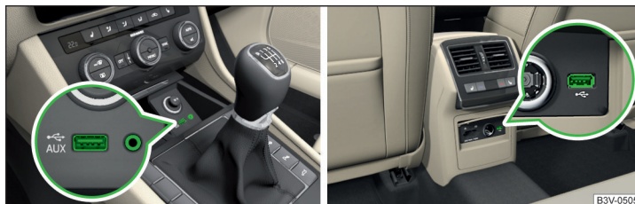
Abb. 109 USB- und AUX-Eingang vorn / USB-Eingang hinten
