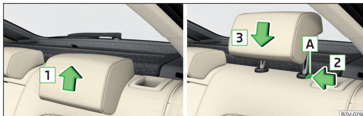
Abb. 97 Höhe der Kopfstütze hinten einstellen
