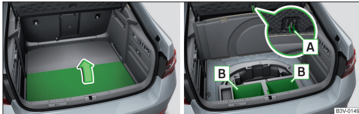
Abb. 152 Variante 1: Bodenbelag anheben / Ablagefächer
