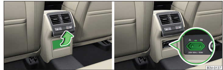
Abb. 131 Abdeckung der 230-Volt-Steckdose aufklappen / 230-Volt-Steckdose
