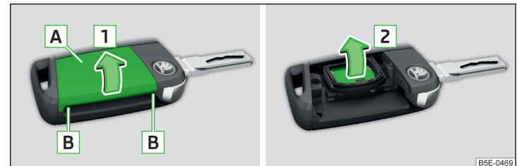
Abb. 347 Abdeckung aufklappen / Batterie herausnehmen
