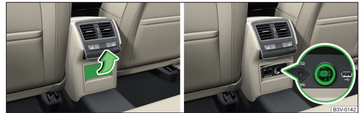
Abb. 128 Abdeckung aufklappen / 12-Volt-Steckdose
