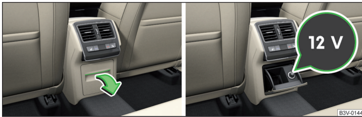
Abb. 129 Ablagefach öffnen / Abdeckung der 12-Volt-Steckdose
