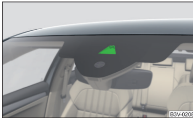
Abb. 310 Sensor für die Verkehrszeichenerkennung
