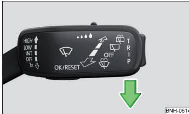
Abb. 357 Servicestellung der Scheibenwischerarme einstellen
