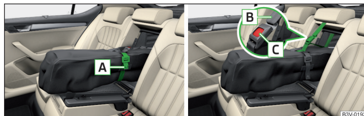
Abb. 126 Band anziehen / Durchladesack sichern
