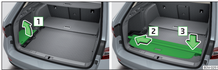
Abb. 148 Seitenabdeckung links abnehmen / Aufrollbare Abdeckung verstauen
