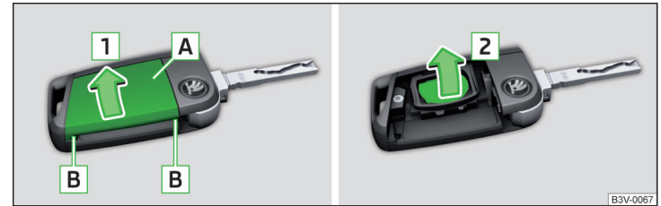
Abb. 254 Funkschlüssel: Abdeckung abbauen / Batterie herausnehmen
