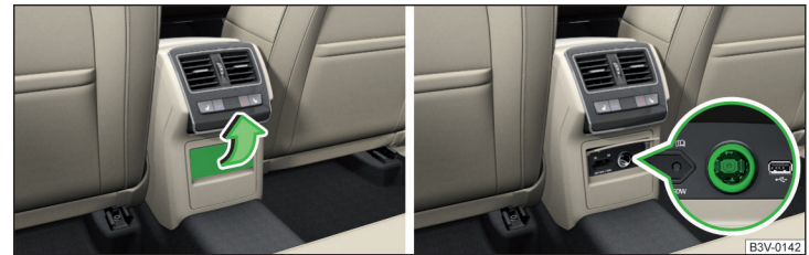
Abb. 113 Abdeckung aufklappen / 12-Volt-Steckdose
