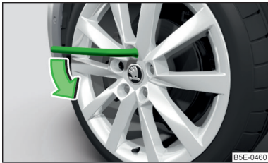
Abb. 245 Radwechsel: Radschrauben lösen
