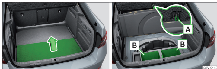
Abb. 141 Variante 1: Bodenbelag anheben / Ablagefächer
