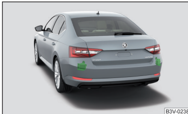
Abb. 214 Einbauort der Radarsensoren
