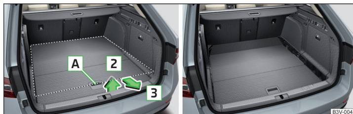
Abb. 144 Variablen Ladeboden in die untere Position einstellen / Variabler Ladeboden in der unteren Position
