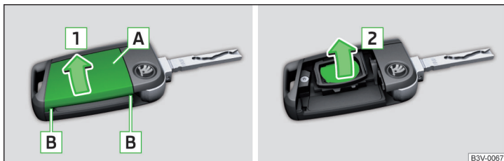
Abb. 253 Funkschlüssel: Abdeckung abbauen / Batterie herausnehmen
