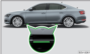
Abb. 245 Aufnahmepunkte für den Wagenheber
