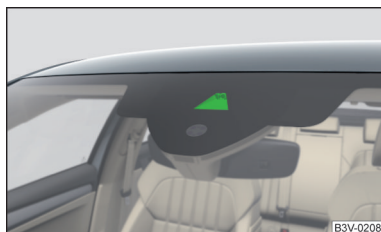
Abb. 216 Sichtbereich der Kamera für die Verkehrszeichenerkennung
