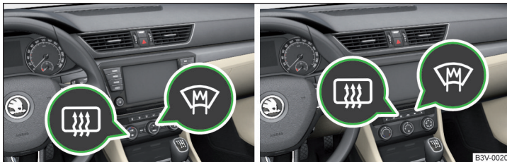
Abb. 63 Tasten für die Front- und Heckscheibenbeheizung: Climatronic / Manuelle Klimaanlage
