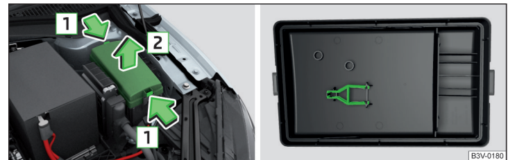
Abb. 268 Abdeckung des Sicherungskastens Abdeckung abnehmen / Kunststoffklammer für Sicherungen
