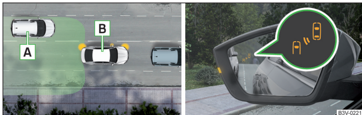
Abb. 214 Fahrsituation / Kontrollleuchte im linken Außenspiegel weist auf die Fahrsituation hin
