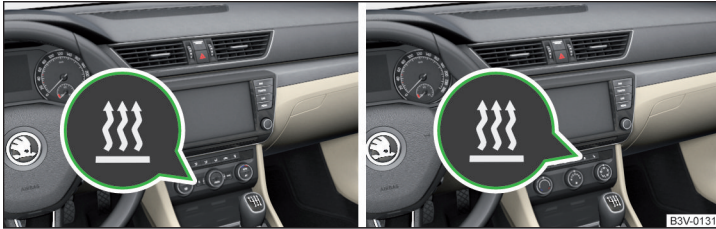
Abb. 157 Taste für direktes Ein-/Ausschalten der Zusatzheizung (Standheizung und -lüftung) auf dem Bedienteil der Climatronic / manuellen Klimaanlage
