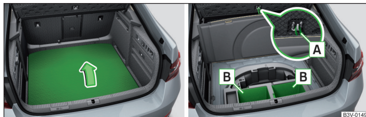
Abb. 139 Variante 1: Bodenbelag anheben / Ablagefächer
