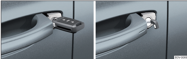
Abb. 259 Griff an der Fahrtür: Schlüssel / KESSY
