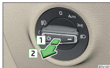
Abb. 55 Lichtschalter: Nebelscheinwerfer und Nebelschlussleuchte einschalten
