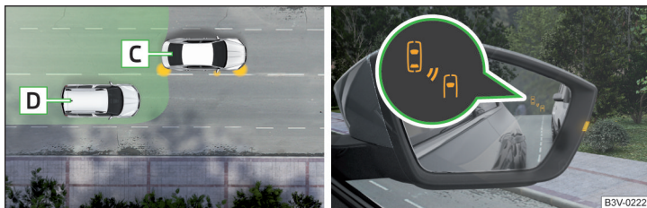
Abb. 215 Fahrsituation / Kontrollleuchte im rechten Außenspiegel weist auf die Fahrsituation hin
