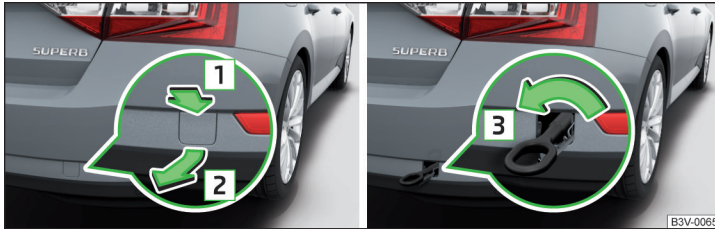
Abb. 252 Ausbau der Abdeckkappe / Einbau der Abschleppöse
