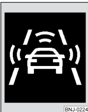
Abb. 207 Symbol im Display des Kombi-Instruments: Vorwarnung bzw. Notbremsung bei niedriger Geschwindigkeit
