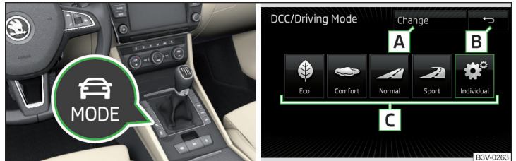
Abb. 209 Taste für die Auswahl des Fahrmodus / Anzeige im Infotainmentdisplay
