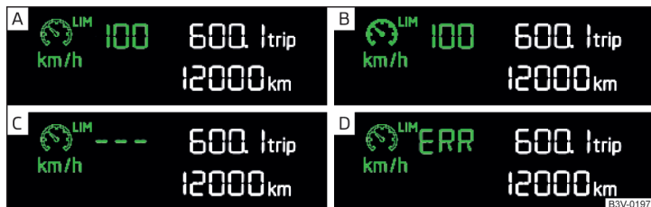
Abb. 197 Segmentdisplay: Beispiele für Zustandsanzeigen des Geschwindigkeitsbegrenzers
