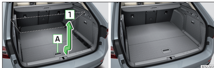
Abb. 143 Variablen Ladeboden in die obere Position einstellen / Variabler Ladeboden in der oberen Position
