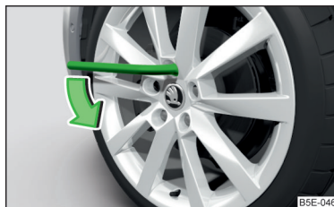
Abb. 244 Radwechsel: Radschrauben lösen
