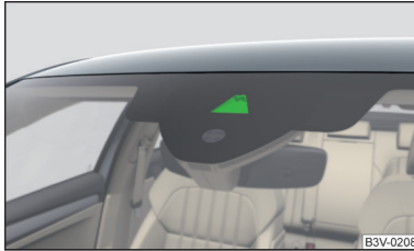
Abb. 199 Sichtbereich der Kamera für die Verkehrszeichenerkennung
