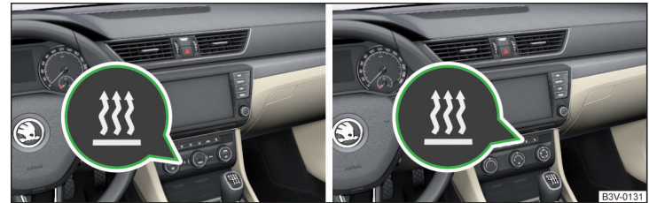
Abb. 141 Taste für direktes Ein-/Ausschalten der Zusatzheizung (Standheizung und -lüftung) auf dem Bedienteil der Climatronic / manuellen Klimaanlage
