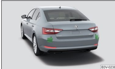
Abb. 196 Einbauort der Radarsensoren
