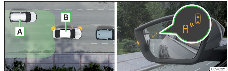
Abb. 197 Fahrsituation / Kontrollleuchte im linken Außenspiegel weist auf die Fahrsituation hin
