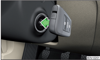
Abb. 145 Motor anlassen - Schlüssel an den Knopf halten
