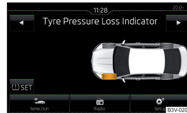
Abb. 201 Taste für Speicherung der Druckwerte / Beispiel der Displayanzeige: das System weist auf eine Reifendruckänderung vorn links hin
