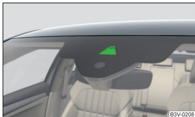
Abb. 56 Kamerasichtfenster für den Scheinwerferassistenten
