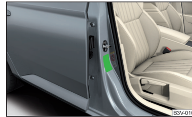
Abb. 14 Aufkleber an der B-Säule auf der Beifahrerseite
