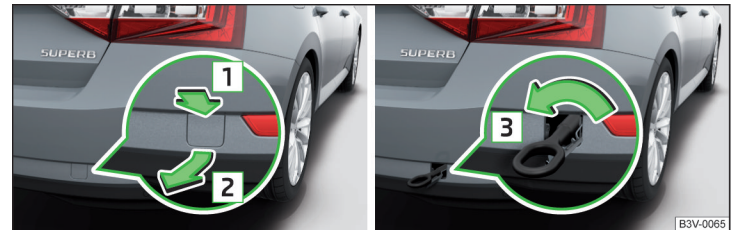
Abb. 234 Ausbau der Abdeckkappe / Einbau der Abschleppöse
