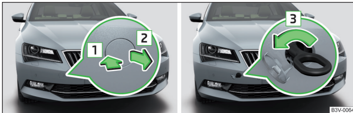
Abb. 233 Ausbau der Abdeckkappe / Einbau der Abschleppöse
