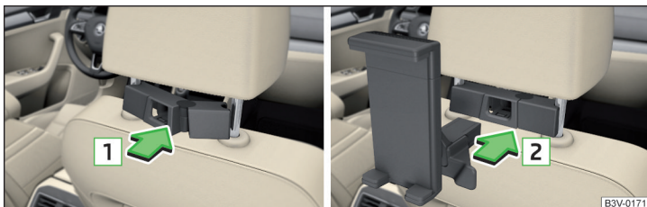
Abb. 118 Adapter an den Führungsstangen der Kopfstütze anbringen / Halter einbauen
