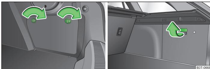
Abb. 175 Ablagefach für den Verbandskasten: Superb / Superb Combi
