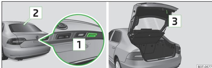
Abb. 20 Griff der Gepäckraumklappe / geöffnete große Gepäckraumklappe
