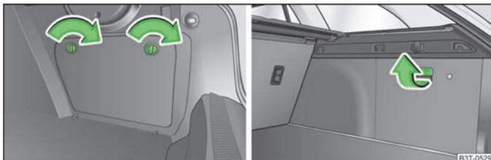
Abb. 170 Ablagefach für den Verbandkasten / Ablagefach für den Verbandkasten (Combi)
