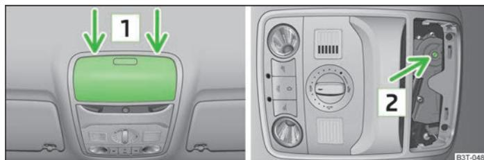
Abb. 26 Ansatzpunkt des Schraubendrehers / Öffnung zum Ansetzen des Schlüssels
