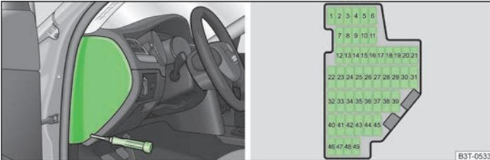
Abb. 183 Abdeckung des Sicherungskastens / Schematische Darstellung des Sicherungskastens
