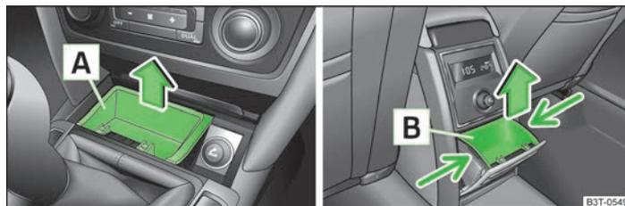
Abb. 84 Mittelkonsole: Aschenbecher vorn / hinten
