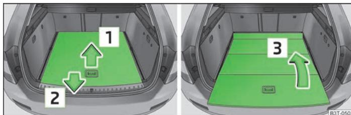
Abb. 74 Gepäckraum: variablen Ladeboden zusammenklappen
