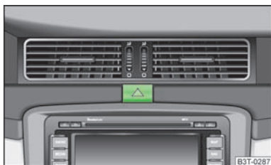
Abb. 37 Schalttafel: Schalter für Warnblinkanlage
