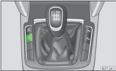
Abb. 172 Taste zum Einstellen des Reifen- druck-Kontrollwerts
