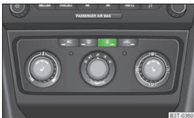
Abb. 110 Taste für direktes Ein-/Ausschalten der Zusatzheizung (Standheizung und -lüftung) auf dem Bedienteil der Klimaanlage
