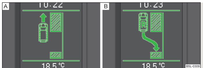
Abb. 122 Informationsdisplay: Parklücke erkannt mit dem Hinweis weiter vorzufahren A und für das Einlegen des Rückwärtsgangs B
