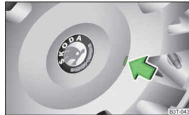
Abb. 171 Radzierkappe bei Leichtmetallrädern abziehen
