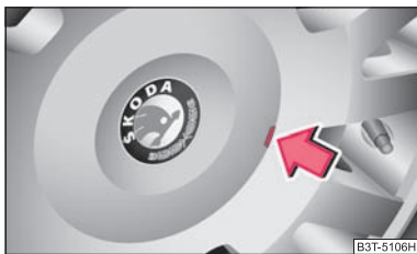
Abb. 197 Abziehen der Radzierkappe bei Leichtmetallrädern
