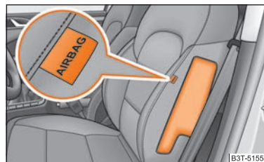
Abb. 157 Einbauort der Seiten-Airbags im Fahrersitz
