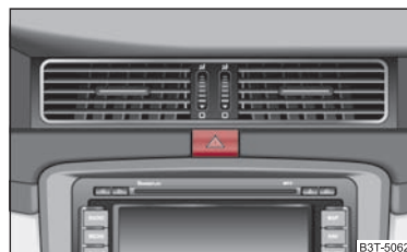
Abb. 51 Schalttafel: Schalter für Warnblinkanlage
