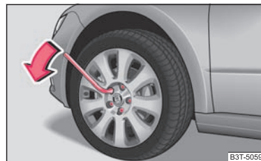
Abb. 198 Radwechsel: Radschrauben lockern
