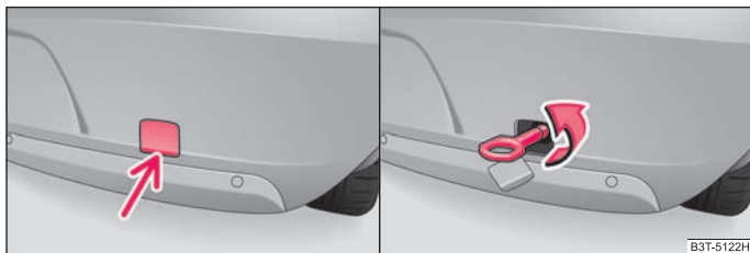
Abb. 204 Hinterer Stoßfänger: Ausbau der Abdeckung / Einbau der Abschleppöse
