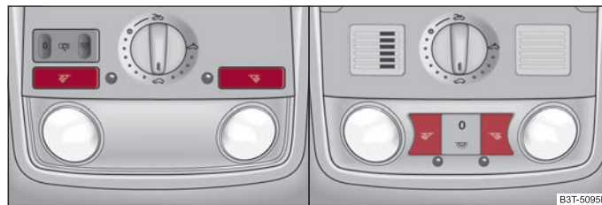
Abb. 54 Ausschnitt des Dachhimmels: Leseleuchten vorn / Leseleuchten vorn mit integrierter Innenraumüberwachung
