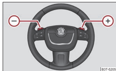
Abb. 139 Multifunktionslenkrad: manuelles Schalten
