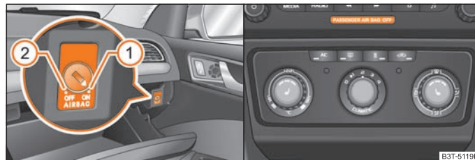
Abb. 161 Ablagefach: Schalter für Front-Beifahrer-Airbag / Kontrollleuchte für Beifahrer-Airbagabschaltung
