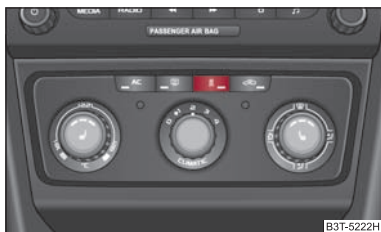
Abb. 123 Taste für direktes Ein-/Ausschalten der Zusatzheizung (Standheizung und -lüftung) auf dem Climatic-Bedienteil
