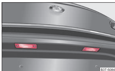
Abb. 217 Hinterer Stoßfänger: Kennzeichenleuchte
