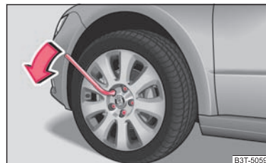
Abb. 198 Radwechsel: Radschrauben lockern
