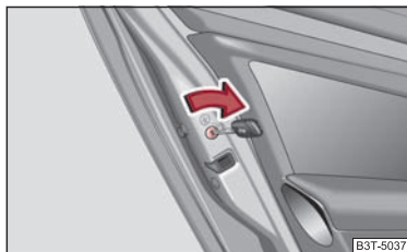
Abb. 25 Kindersicherung an den hinteren Türen
