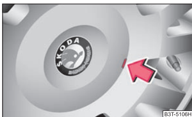
Abb. 197 Abziehen der Radzierkappe bei Leichtmetallrädern
