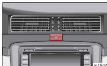
Abb. 51 Schalttafel: Schalter für Warnblinkanlage
