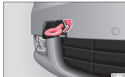
Abb. 225 Vordere Stoßfänger-Abschleppöse: Einbau der Abschleppöse
