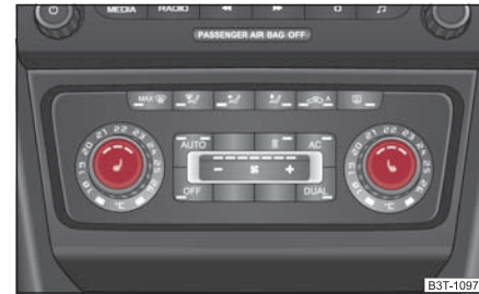
Abb. 87 Schalttafel: Regler für Sitzheizung vorn
