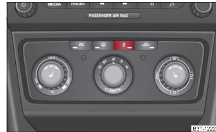
Abb. 129 Taste für direktes Ein-/Ausschalten der Zusatzheizung (Standheizung und -lüftung) auf dem Climatic-Bedienteil
