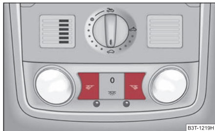
Abb. 65 Ausschnitt des Dachhimmels: Leseleuchten vorn mit integrierter Innenraumüberwachung
