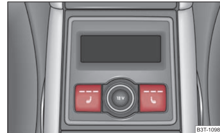
Abb. 88 Mittelkonsole hinten: Regler für Beheizung der Rücksitze
