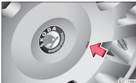
Abb. 218 Abziehen der Radzierkappe bei Leichtmetallrädern
