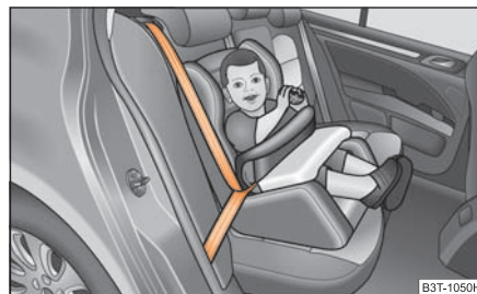
Abb. 184 In Fahrrichtung eingebauter Kindersitz mit Sicherheitstisch nach Gruppe 1 auf der Rückbank
