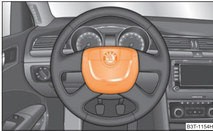
Abb. 169 Fahrer-Airbag im Lenkrad
