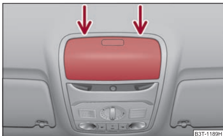
Abb. 53 Ausschnitt des Dachhimmels: Ansatzpunkt des Schraubendrehers
