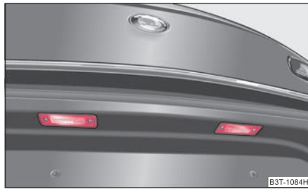
Abb. 242 Hinterer Stoßfänger: Kennzeichenleuchte
