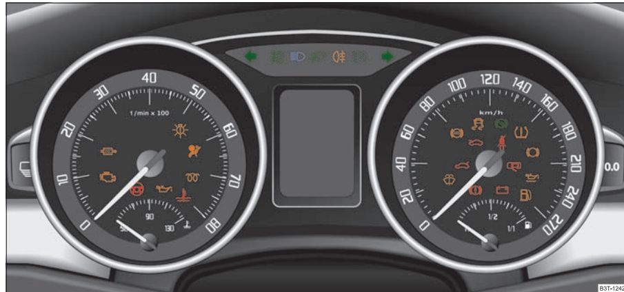
Abb. 35 Kombiinstrument mit Kontrollleuchten
