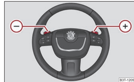
Abb. 150 Multifunktionslenkrad: manuelles Schalten ▶
