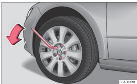
Abb. 219 Radwechsel: Radschrauben lockern
