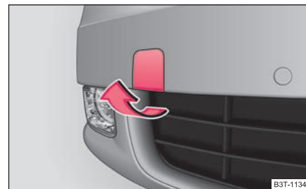
Abb. 224 Vordere Stoßfänger-Abdeckung: Ausbau der Abdeckung
