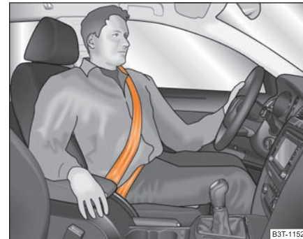
Abb. 165 Gurtbandverlauf des Schulter- und Beckengurtes
