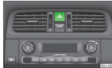
Abb. 25 Schalttafel: Taste für Warnblinkanlage
