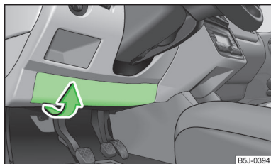
Abb. 153 Unterseite der Schalttafel: Abdeckung des Sicherungskastens
