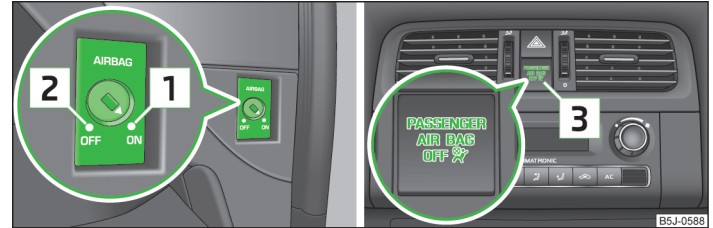
Abb. 120 Schlüsselschalter für Beifahrer-Frontairbag / Kontrollleuchte für Beifahrer-Frontairbagab/-einschaltung
