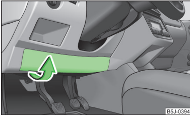
Abb. 152 Unterseite der Schalttafel: Abdeckung des Sicherungskastens
