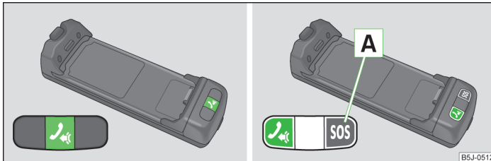
Abb. 87 Prinzipdarstellung: Adapter mit einer Taste / Adapter mit zwei Tasten
