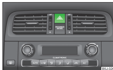
Abb. 25 Schalttafel: Schalter für Warnblinkanlage
