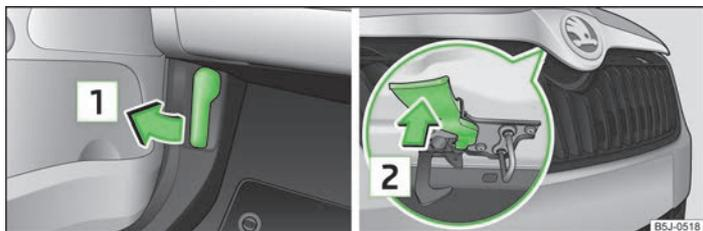
Abb. 113 Entriegelungshebel für Motorraumklappe / Kühlergrill: Entriegelungshebel
