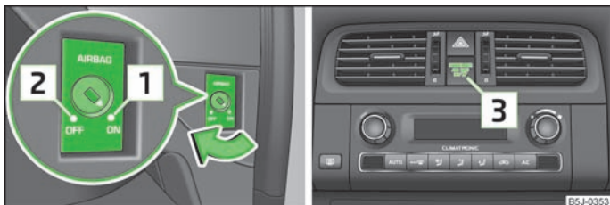
Abb. 103 Schlüsselschalter für Beifahrer-Frontairbag / Kontrollleuchte für Beifahrer- Frontairbagabschaltung
