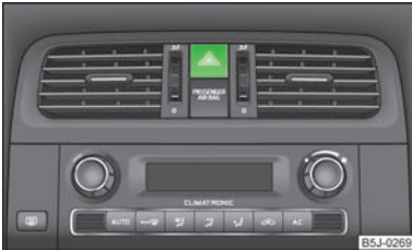
Abb. 23 Schalttafel: Schalter für Warnblinkanlage
