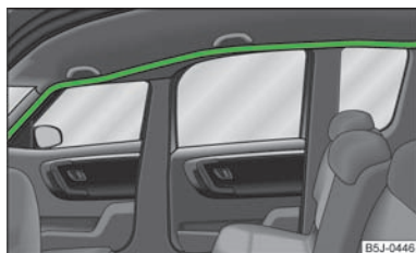
Abb. 101 Einbauort des Kopfairbags
