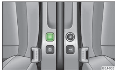
Abb. 82 Mittelkonsole: Taste für das START-STOPP-System
