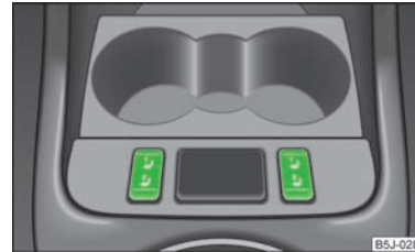
Abb. 34 Wippschalter für Sitzheizung vorn
