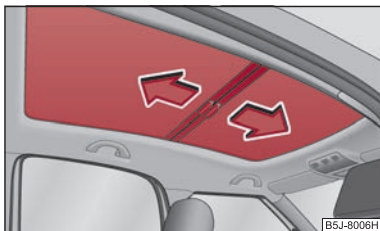
Abb. 33 Panoramadach: Sonnenschutzrollo öffnen
