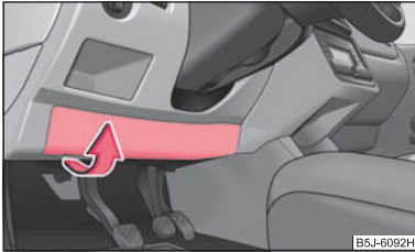
Abb. 156 Untere Seite der Schalttafel: Sicherungsdeckel
