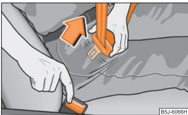
Abb. 109 Lösen der Schloßzunge vom Gurtschloß
