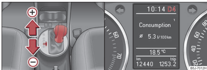
Abb. 98 Manuelles Schalten: Wählhebel / großes Informationsdisplay
