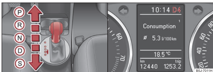
Abb. 97 Wählhebel / Informationsdisplay: Wählhebelstellungen
