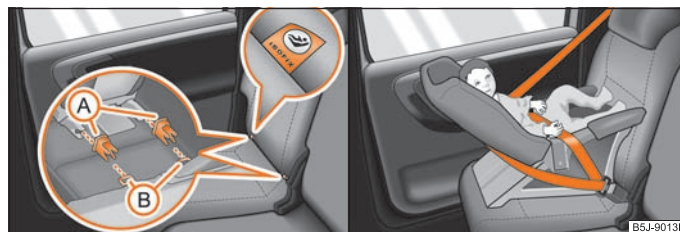
Abb. 124 Halteösen (ISOFIX-System) / der ISOFIX-Kindersitz wird in die montierten Aufnahme-trichter geschoben
