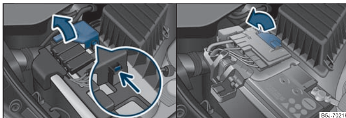
Abb. 140 Batterie: Abdeckung hochklappen (automatisches Getriebe) / (Schaltgetriebe)
