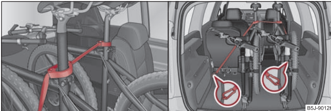
Abb. 69 Absicherung der Fahrräder mit Schellen / mit einem Band
