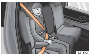
Abb. 123 In Fahrtrichtung eingebauter Kindersitz nach Gruppe 3 auf dem Rücksitz
