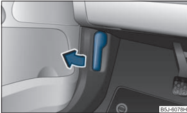
Abb. 134 Entriegelungshebel für Motorraumklappe
