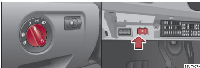
Abb. 34 Schalttafel: Lichtschalter / Schalter für Tagfahrlicht
