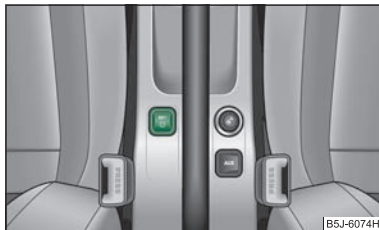
Abb. 127 Taste zum Einstellen des Reifendruck-Kontrollwertes
