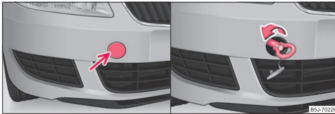
Abb. 154 Vorderer Stoßfänger: Schutzgitter / Einbau der Abschleppöse
