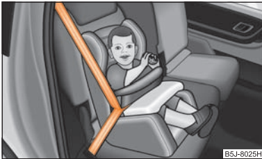
Abb. 121 In Fahrtrichtung eingebauter Kindersitz mit Sicherheitstisch nach Gruppe 1 auf der Rücksitzbank
