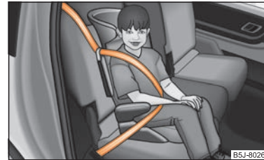
Abb. 122 In Fahrtrichtung eingebauter Kindersitz nach Gruppe 2 auf dem Rücksitz
