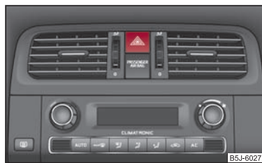
Abb. 37 Schalttafel: Schalter für Warnblinkanlage
