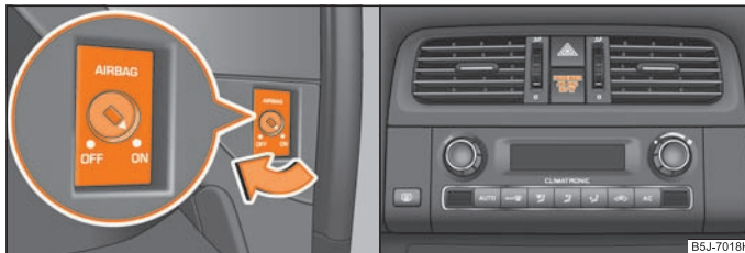
Abb. 117 Schalter für Front-Beifahrer-Airbag / Kontrollleuchte für Beifahrer-Airbagabschaltung
