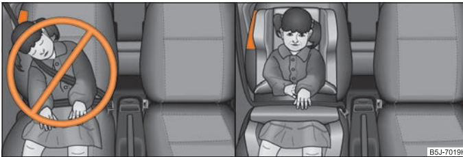
Abb. 119 Nicht richtig gesichertes Kind / Mit einem Kindersitz vorschriftsmäßig gesichertes Kind
