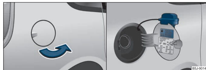
Abb. 133 Fahrzeugseite hinten rechts: Tankklappe / Tankklappe mit abgeschraubtem Verschluss
