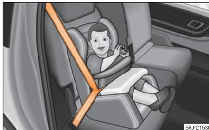
Abb. 159 In Fahrtrichtung eingebaute Kindersitz mit Sicherheitstisch nach Gruppe 1 auf der Rückbank
