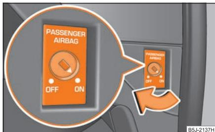
Abb. 153 Schalter für Beifahrer-Airbag(s)
