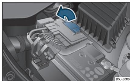
Abb. 182 Batterie: Abdeckung hochklappen (Schaltgetriebe)
