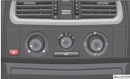
Abb. 54 Schalter für Heckscheibenbeheizung
