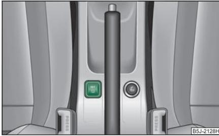
Abb. 167 Taste zum Einstellen des Reifendruck-Kontrollwertes
