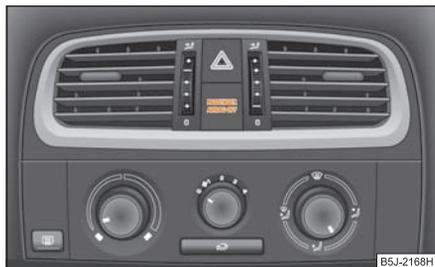
Abb. 154 Kontrollleuchte für Beifahrer-Airbagabschaltung
