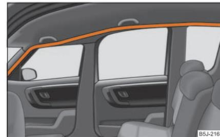
Abb. 151 Einbauort des Kopf-Airbags
