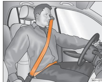
Abb. 141 Gurtbandverlauf des Schulter- und Beckengurtes
