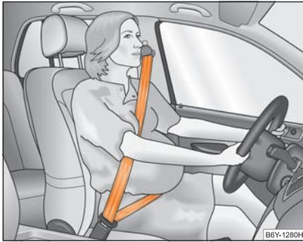
Abb. 142 Gurtbandverlauf bei schwangeren Frauen
