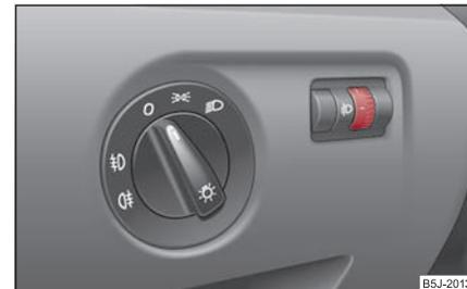
Abb. 49 Schalttafel: Leuchtweitenregulierung
