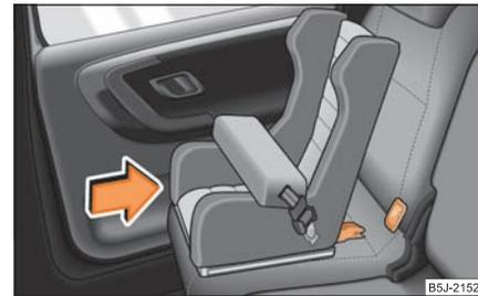
Abb. 163 Der ISOFIX-Kindersitz wird in die montierten Aufnahmetrichter geschoben
