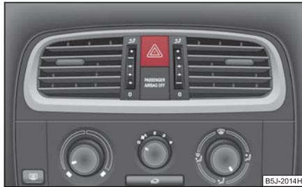
Abb. 50 Schalttafel: Schalter für Warnblinkanlage
