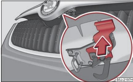
Abb. 15 Kühlergrill: Sicherungshebel
