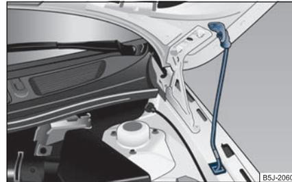
Abb. 176 Sicherung der Motorraumklappe mit der Klappenstütze
