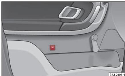
Abb. 42 Taste der Innenraumüberwachung
