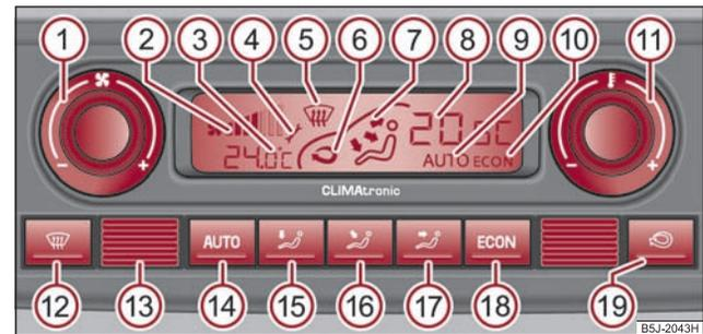
Abb. 117 Climatronic: Bedienelemente
