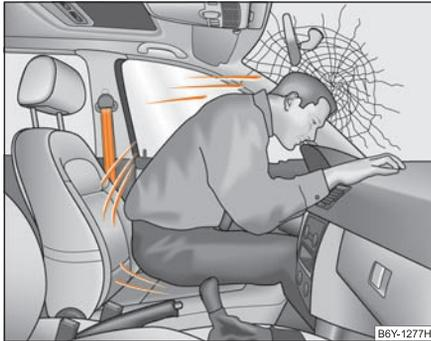
Abb. 139 Der nicht angegurte Fahrer fliegt nach vorn
