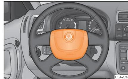
Abb. 145 Fahrer-Airbag im Lenkrad
