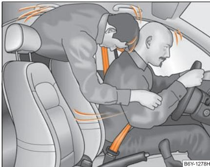
Abb. 140 Der nicht angegurte Mitfahrer auf dem Rücksitz fliegt nach vorn
