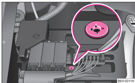
Abb. 162 Batterie mit Ladezustand-Indikator
