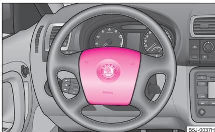
Abb. 125 Fahrer-Airbag im Lenkrad
