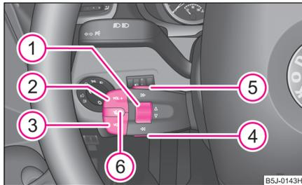
Abb. 110 Multifunktionsmodul: Tasten für die Radiobedienung
