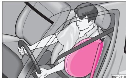
**Abb. 130 Seiten-Airbag ausgelöst**
