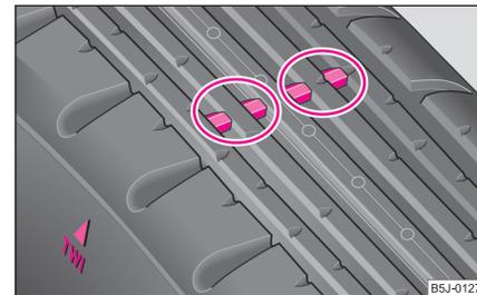
**Abb. 165** Reifenprofil mit Verschleißanzeiger
