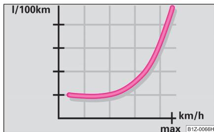
**Abb. 150 Kraftstoffverbrauch in l/100 km und Geschwindigkeit in km/h**
