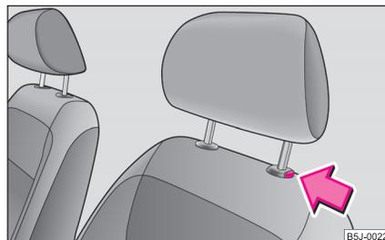
Abb. 47 Kopfstütze herausziehen
