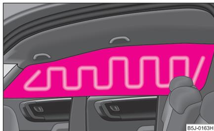
**Abb. 132** Gasgefüllter Kopf-Airbag
