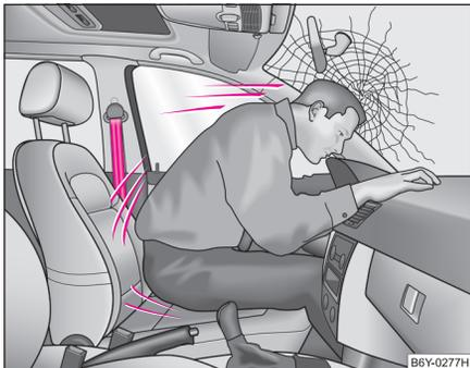
**Abb. 119** Der nicht angegurtete Fahrer fliegt nach vorn
