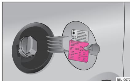
Abb. 164 Geöffnete Tankklappe mit Reifenfülldrucktabelle
