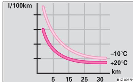
Abb. 151 Kraftstoffverbrauch in l/100 km bei verschiedenen Temperaturen
