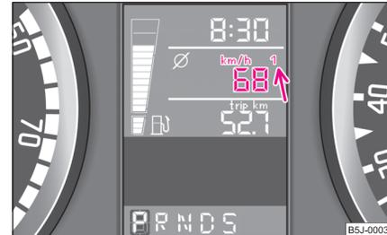
Abb. 5 Kombiinstrument: Multifunktionsanzeige
