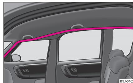
Abb. 131 Einbauort des Kopf-Airbags
