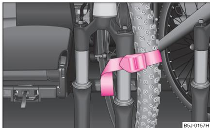
Abb. 68 Befestigung des Vorderrades
