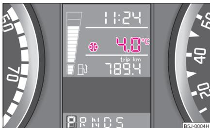
Abb. 7 Multifunktionsanzeige: die Außentemperatur
