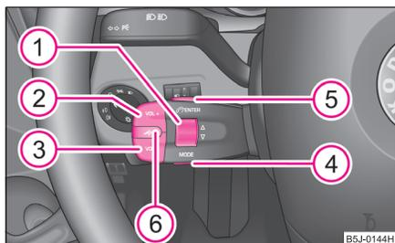
**Abb. 111 Multifunktionsmodul: Tasten für die Radio- und Telefonbedienung**
