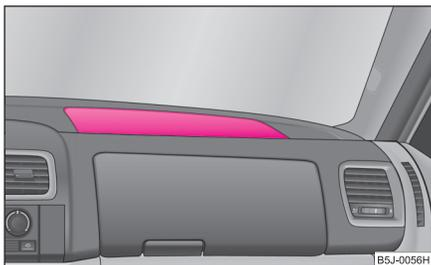
Abb. 126 Beifahrer-Airbag in der Schalttafel
