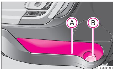
Abb. 87 Ablagefach in der Türverkleidung
