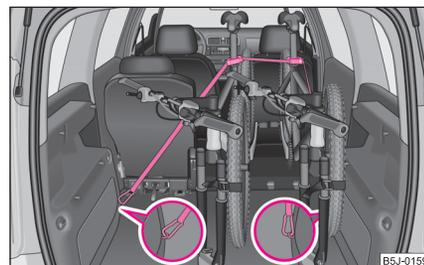
Abb. 70 Absicherung der Fahrräder mit einem Band
