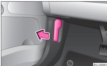
Abb. 154 Entriegelungshebel für Motorraumklappe
