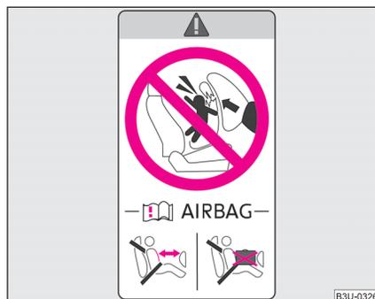
**Abb. 135** Aufkleber an der mittleren Karoseriesäule auf der Beifahrersseite
