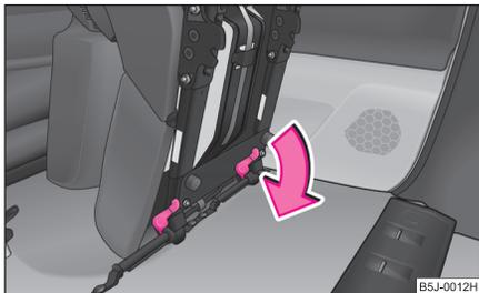
Abb. 54 Entriegelung des vorgeklappten Sitzes
