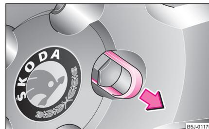
Abb. 171 Radwechsel: Abdeckkappe von der Radschraube abziehen
