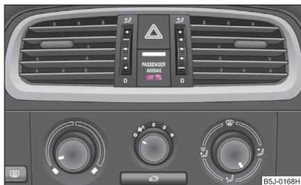
Abb. 134 Kontrollleuchte für Beifahrer-Airbagabschaltung
