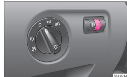
Abb. 34 Schalttafel: Leuchtweitenregulierung
