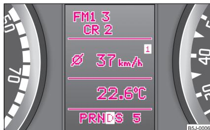
Abb. 8 Kombiinstrument: Informationsdisplay
