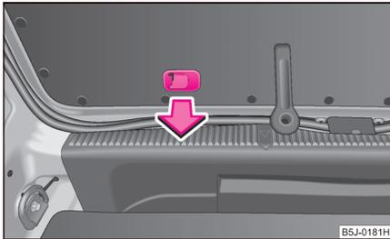
Abb. 202 Notentriegelung der Laderaumklappe
