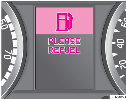
Abb. 14 Informationsdisplay: Kraftstoffvorrat niedrig
