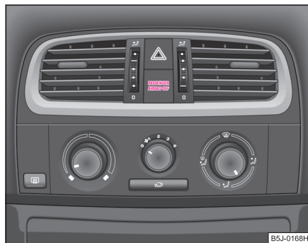
Abb. 134 Kontrollleuchte für Beifahrer-Airbagabschaltung
