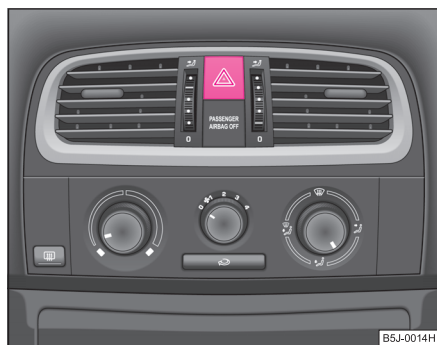
Abb. 36 Schalttafel: Schalter für Warnblinkanlage
