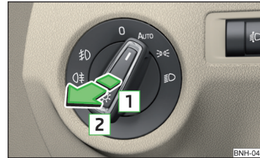
Abb. 57 Lichtschalter - Nebelscheinwerfer/Nebelschlussleuchte einschalten
