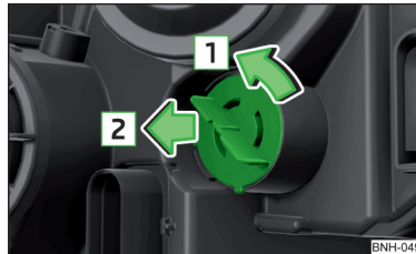
Abb. 267 Glühlampe für Blinklicht vorn wechseln
