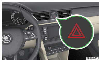
Abb. 58 Taste für Warnblinkanlage
