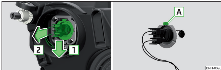
Abb. 266 Glühlampe für Abblendlicht wechseln
