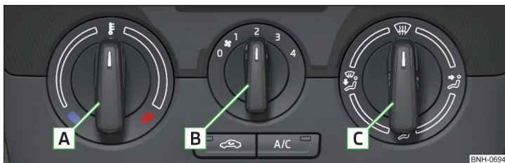
Abb. 110 Bedienelemente der Heizung/Klimaanlage
