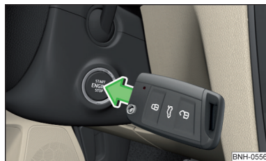
Abb. 181 Motor anlassen - Knopf mit dem Schlüssel drücken
