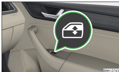
Abb. 52 Taste des Fensterhebers auf der Beifahrerseite
