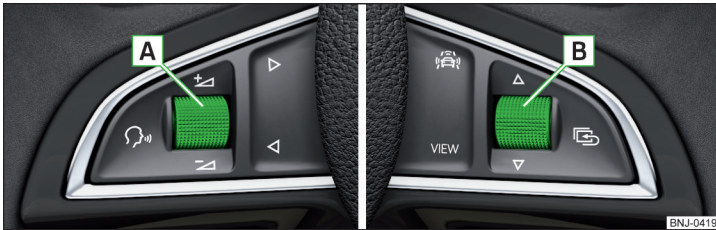
Abb. 39 Tasten/Einstellräder am Multifunktionslenkrad
