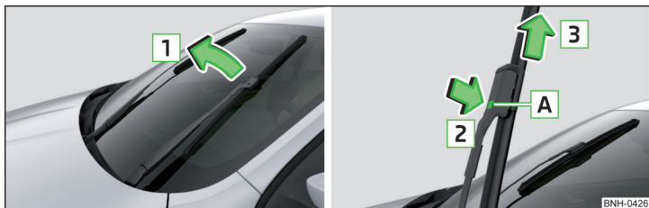
Abb. 255 Scheibenwischerblatt der Frontscheibe auswechseln
