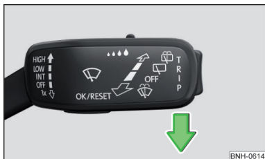
Abb. 254 Servicestellung der Scheibenwischerarme einstellen
