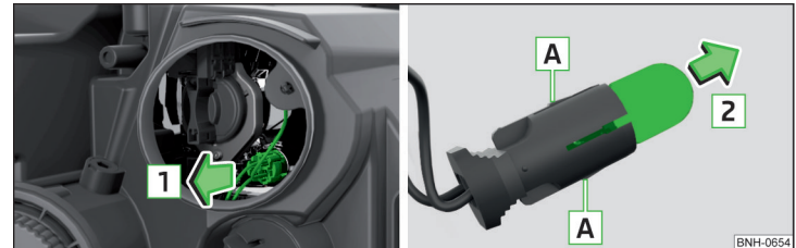
Abb. 265 Glühlampe für Standlicht wechseln
