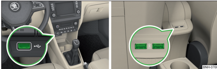
Abb. 78 USB-Eingang vorn / USB-Eingänge hinten
