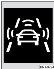
Abb. 207 Display des Kombi-Instruments: Vorwarnung bzw. Notbremsung bei niedriger Geschwindigkeit
