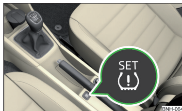
Abb. 210 Taste für Speicherung der Druckwerte
