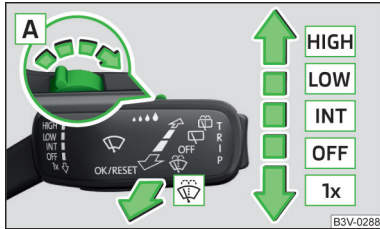
Abb. 63 Bedienung der Scheibenwischer- und Waschanlage vorn
