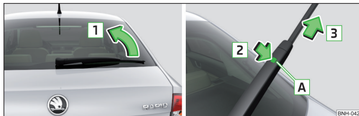
Abb. 256 Scheibenwischerblatt der Heckscheibe auswechseln
