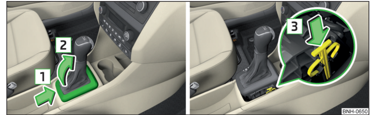
Abb. 253 Abdeckung abnehmen / Wählhebel entriegeln
