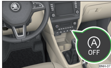
Abb. 183 Taste für das START-STOPP-System
