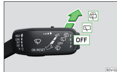
Abb. 64 Bedienung der Scheibenwischer- und Waschanlage
