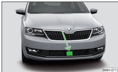
Abb. 191 Verbauort des Radarsensors
