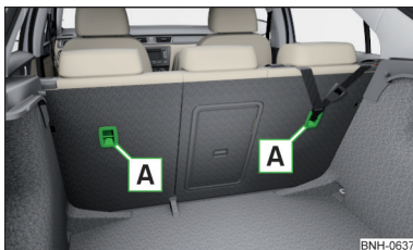
Abb. 28 Halteösen des TOP TETHER -Systems
