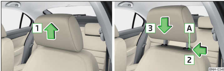
Abb. 71 Höhe der Kopfstütze einstellen
