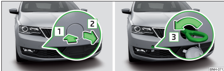
Abb. 247 Abdeckkappe abnehmen / Abschleppöse einbauen
