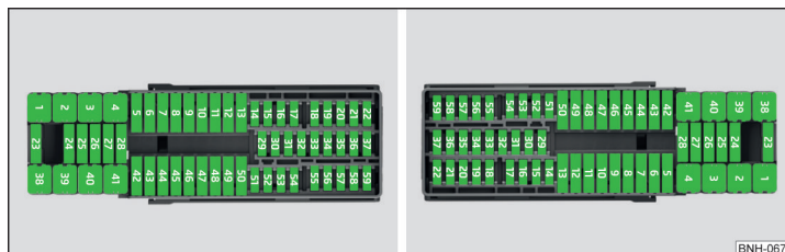
Abb. 180 Sicherungen: Linkslenkung / Rechtslenkung
